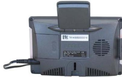
Lorsque le Traffic Assist n'est pas utilisé pour la navigation, l'antenne doit toujours être rabattue contre l'appareil. Pour le mode navigation, il suffit que l'antenne soit orientée à peu près à l'horizontale.
