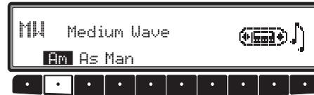
Appuyez plusieurs fois sur la touche multifonction **Am** pour choisir entre les gammes d'ondes PO (MW Medium Wave), GO (LW Long Wave) et OC (SW Short Wave).
