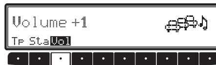
Avec le bouton de droite **Vol**, vous pouvez procéder à quatre réglages (0 à 3). Autrement dit, selon le réglage, le volume est augmenté d'une valeur fixe au passage d'un message d'information routière.
