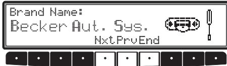
Vous pouvez sélectionner les différents points avec les touches multifonctions **Nxt** et **Prv** ou en tournant le bouton de droite ●.
