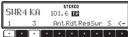
Si vous avez déjà sélectionné un programme de cette chaîne d'émetteurs, l'appareil revient au dernier programme réglé sans qu'il soit nécessaire d'entrer de nouveau le programme. La touche multifonction **->** signifie qu'il est possible de sélectionner et de faire apparaître d'autres stations à l'écran en appuyant sur ces touches.
