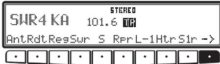
Appuyez sur la touche se trouvant sous l'abréviation de l'organisme d'émission radio, pour sélectionner la station souhaitée. Si l'organisme d'émission radio souhaitée diffuse plusieurs programmes/programmes régionaux, il est possible de sélectionner le programme souhaité dans un sous-menu qui s'affiche automatiquement à l'écran.
