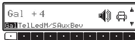
Les réglages GAL permettent de fixer le début de la hausse du volume en fonction de la vitesse du véhicule.
