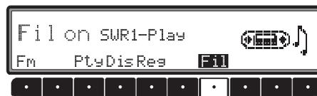
Sélectionnez les différents programmes avec le bouton de droite ●. Appuyez sur le bouton de droite ● pour sélectionner **Play** (Programme non filtré) et **Skif** (Programme filtré). Pour activer et désactiver la fonction de filtrage, appuyez plusieurs fois sur la touche multifonction **Fil** (**Fil on** (activer la fonction de filtrage)) ou (**No Fil** (désactiver la fonction de filtrage)).
