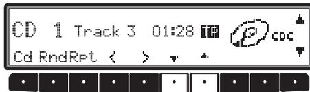
Vous pouvez sélectionner les différents CD dans le chargeur en appuyant sur les touches multifonctions
