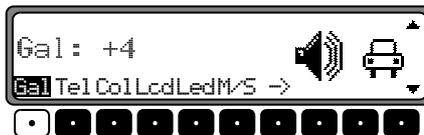
Les réglages GAL permettent de fixer le début de la hausse du volume en fonction de la vitesse du véhicule.
