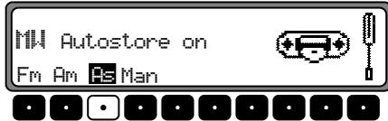
Appuyez sur la touche multifonctionnelle **AS** autant de fois que nécessaire jusqu'à ce que **Autostore on** apparaisse sur l'afficheur.
