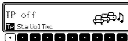
Lorsque l'appareil repasse en mode d'affichage normal, la fonction TP est désactivée.
