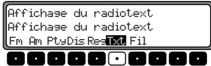
L'autoradio filtre une information du radiotexte parmi les données offertes par la station et la fait apparaître à l'afficheur.
