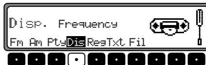
La touche multifonctionnelle **Dis** permet de choisir entre Frequency (Affichage de fréquence activé) ou PTV (Affichage de fréquence désactivé).
