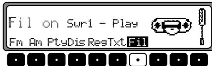
Sélectionnez les différents programmes avec le bouton rotatif de droite ●. En appuyant sur le bouton rotatif de droite ● il est possible de sélectionner Play (Programme non filtré) et Skif (Programme filtré).
