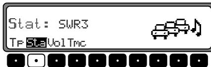
Sélectionnez la station TP souhaitée en utilisant le bouton rotatif droit. Si vous n'effectuez aucune opération, la station sélectionnée s'affiche quelques secondes plus tard.
