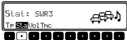
Avec le bouton rotatif de droite
