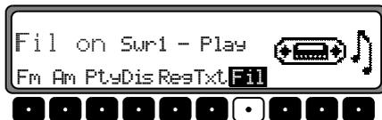
Sélectionnez les différents programmes avec le bouton rotatif de droite ●. ● il est possible de sélectionner Play (Programme non filtré) et Skip (Programme filtré).
