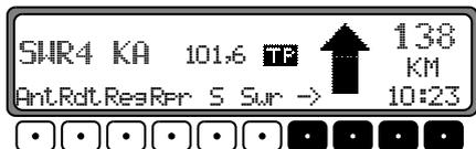
Appuyez sur la touche, se trouvant sous l'abréviation de l'organisme d'émission radio, pour sélectionner la station souhaitée. Si la station souhaitée diffuse plusieurs programmes/programmes régionaux, il est possible de sélectionner le programme désiré dans un sous-menu qui apparaît automatiquement à l'afficheur.
