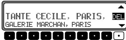
Sélectionnez la destination à effacer avec le bouton rotatif de droite et appuyez sur la touche multifonctionnelle DEL.
