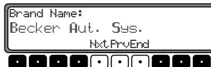
Avec les touches multifonctionnelles **Nxt** et **Prv** ou en tournant le bouton rotatif de droite ●, vous pouvez sélectionner les divers points.
