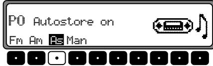
Appuyez sur la touche multifonctionnelle **As** jusqu'à ce que **Autostore on** apparaisse sur l'afficheur.
