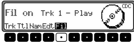
Pour le changeur de CD Silverstone 2660, il est possible de sélectionner les différents titres des CD avec le bouton rotatif de droite ●. Appuyez sur le bouton rotatif de droite ● pour commuter entre **Play** (page non filtrée) et **Skip** (page filtrée)
