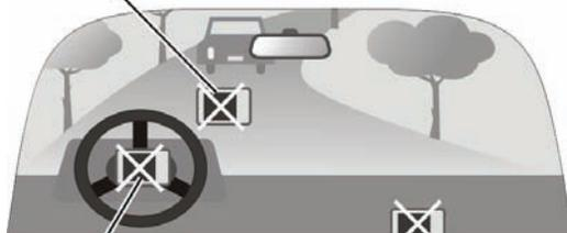
Ne pas monter l'appareil sur les panneaux des airbags.
