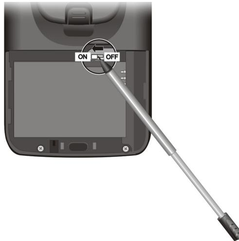
3. Installez la batterie à l'emplacement en insérant d'abord l'extrémité terminal de la batterie sur un angle (❶) aux pins du connecteur dans l'emplacement et en appuyant l'extrémité gauche de la batterie.
