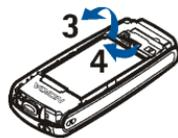
2. Retirez la batterie en soulevant son extrémité grâce aux griffes d'accrochage (3). Ouvrez le volet de la carte SIM en le faisant pivoter (4).
