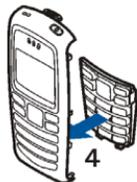
3. Insérez le tapis du clavier dans la nouvelle façade avant (4).
