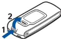
1. Pressez le bouton de déverrouillage de la façade arrière (1), soulevez la façade arrière par le sommet (2) et retirez-la.
