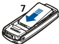
4. Vérifiez que les connecteurs dorés de la batterie sont en face des connecteurs correspondants du téléphone et poussez la batterie par l'extrémité opposée jusqu'à ce qu'elle s'enclenche (7).
