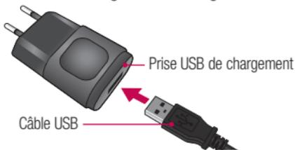
**REMARQUE** : Assurez-vous que la batterie soit en place avant de brancher le chargeur mural. Si vous branchez le chargeur mural alors que la batterie n'est pas installée, le téléphone ne fonctionnera pas correctement en raison d'un cycle d'alimentation prolongé. Par ailleurs, le fait d'enlever la batterie lorsque le chargeur mural est branché risque d'endommager le téléphone. Veuillez débrancher le chargeur mural avant d'enlever la batterie.
