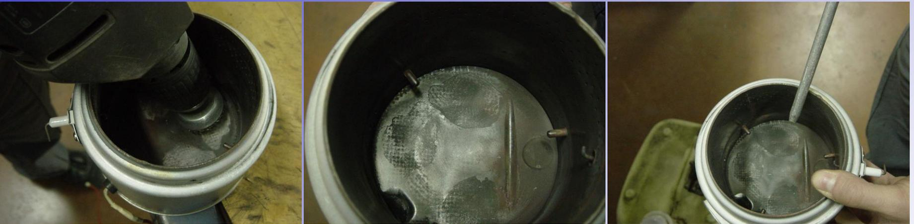
Nettoyage de la chambre de combustion,
