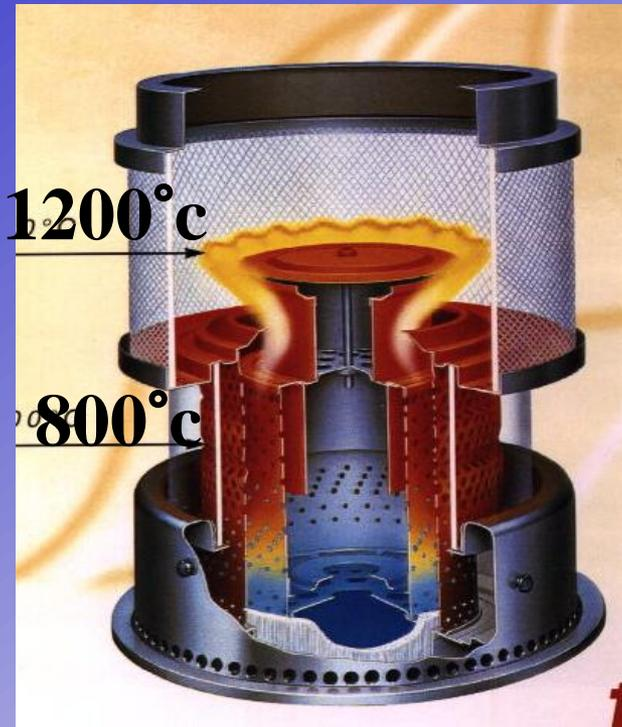
La première partie de la combustion est identique au brûleur à flux laminaire ( 800°). Durant la combustion , un apport d'oxygène dans la partie supérieur du brûleur permet d'obtenir une combustion presque complète, d'où l'apparition d'une flamme (1200°). Ce type de brûleur a un rayonnement de 30% et une convection de 70 % . Ces appareils brûlent principalement le monoxyde de Carbone (C O ).
