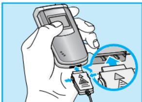
1. Insérez une extrémité du chargeur de voyage dans la base du téléphone.
