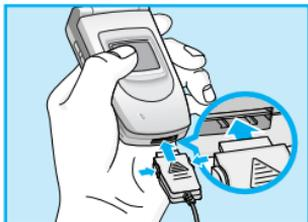
1. Insérez l'une des extrémités du chargeur dans le connecteur prévu à cet effet.
