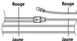
Après avoir fait correspondre correctement les raccordements et les câbles d'alimentation commutée, raccordez l'appareil à l'alimentation du véhicule. Si vous avez des questions et des problèmes de raccordement de cet appareil, qui ne sont pas abordés dans ce mode d'emploi, contactez votre concessionnaire automobile.
