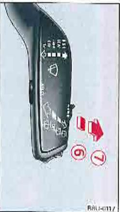
Fig. 51 - Actionnement de l'essuie-glace arrière
