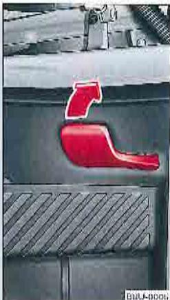
Fig. 164 : Plancher côté conducteur - levier de déverrouillage
