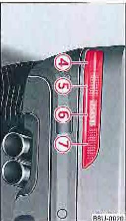
Fig. 204. Arrière du véhicule : ampoules dans le pare-chocs.
