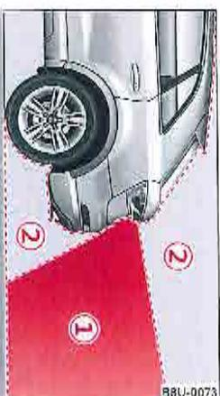
Fig. 112. Zone de champ de vision et zone de détecteurs et champ de vision de la caméra de recul.
