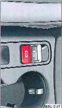
Fig. 85 Vue partielle de la console centrale : touche de l'assistant de démarrage.
