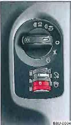
Fig. 40 Tableau de bord : commande d'éclairage avec réglage du site des phares
