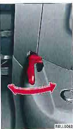
Fig. 80 : Ajuster sous la colonne de direction.
