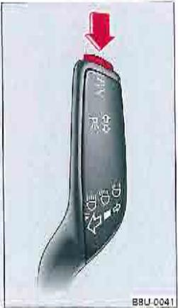
Fig. 96. Levier de direction : touche du système active lane assist
