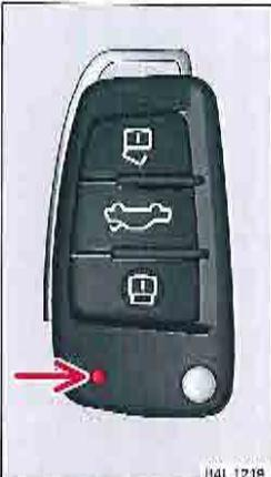
Fig. 25 Clé à radiocommande : LED
