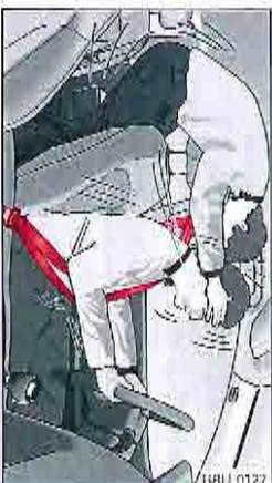
Fig. 138. Le passager avant non attaché est projeté vers l'avant
