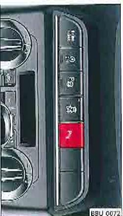
Fig. 108. Console centrale : touche d'aide au stationnement
