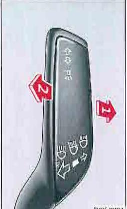
Fig. 42 - Levier des clignotants et des feux de route : activation/désactivation de l'assistant de feux de route
