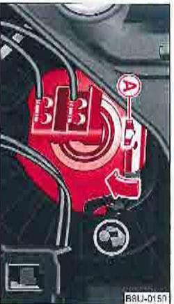
Fig. 210 - Connecteur en plastique : repose du feu de croisement
