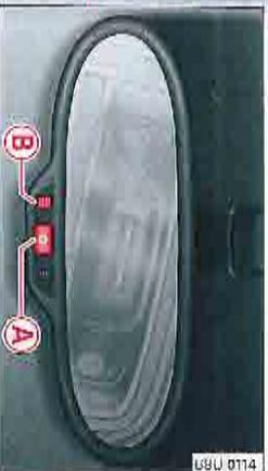
Fig. 48. Rétroviseur intérieur photosensible.
