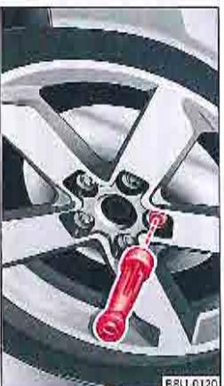
Fig. 191. Démontage de roue : six pans creux pour le serrage des boulons.
