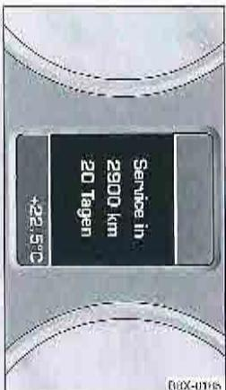
Fig. 15. Combiné d'instruments : indicateur de périodicité d'entretien sur les véhicules avec système d'information du conducteur.
