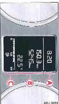
Fig. 4. Écran sur les véhicules sans système d'information du conducteur.
