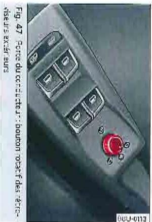
Fig. 47. Perte du conducteur : bouton rotatif des rétroviseurs extérieurs.
