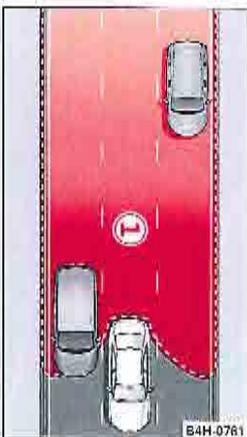
Fig. 100 Zone de couverture des capteurs
