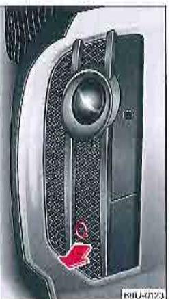
Fig. 195 Avant du véhicule : retrait du cache
