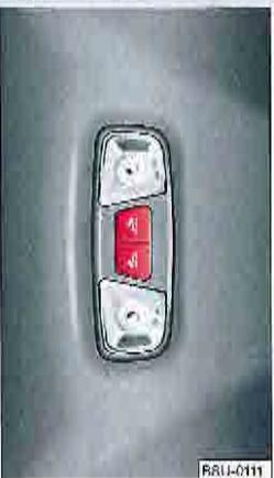
Fig. 45 Partie arrière du ciel de plancher : commandes de lecture à LED
