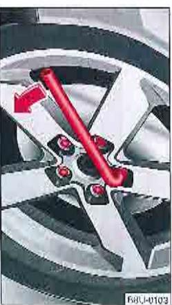
Fig. 188. Changement de roue : desserrage des boulons de roue
