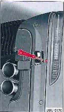
Fig. 222. Bloc d'éclairage dans le pare-chocs. Vis de fixation
