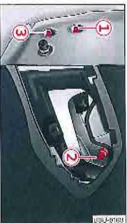
Fig. 220. Cote inférieure du hayon : écrous
