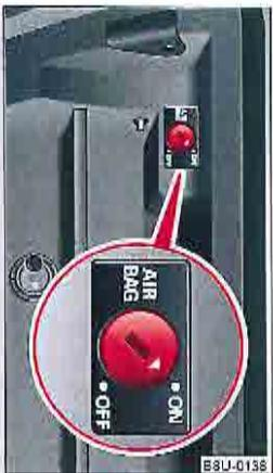
Fig. 153 Boîte à gants : commande à clé permettant de désactiver l'airbag du passager avant.
