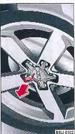
Fig. 186. Démontage de roue : retrait du capuchon de roue
