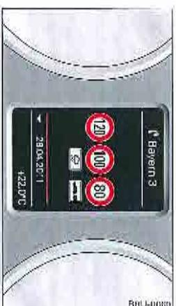
Fig. 21. Combinaison d'instruments : exemple d'affichage des limitations de vitesse
