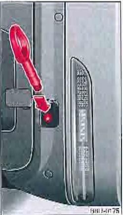
Fig. 198 Pare-chocs arrière : vissage de l'ocillet de remorquage
