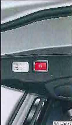
Fig. 32 - Face frontale de la porte du conducteur: dispositif de surveillance de l'habitacle et du dispositif anti-remorquage.
