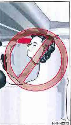
Fig. 127 Représentation schématisée d'une position possible d'un enfant dans la zone de déclenchement de l'airbag latéral.
