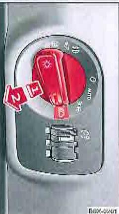
Fig. 39 Tableau de bord : commande d'éclairage avec phares à commande automatique
