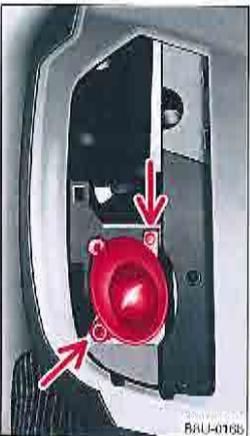
Fig. 217. Phare antibrouillard : vis de fixation
