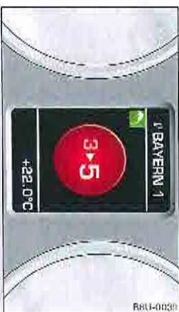
Fig. 18. Combinaison d'instruments : indicateur élargi de changement de rapport sur les véhicules dotés d'un écran multicolore
