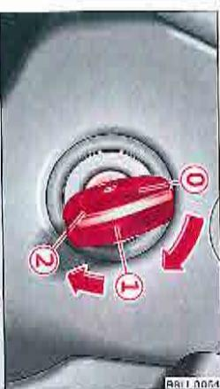
Fig. 81 : Contact-démarreur : positions de la clé de contact.
