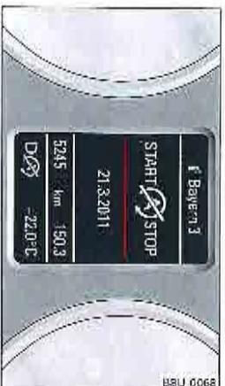
Fig. 87 Combinaison d'instruments : fonction d'arrêt du moteur \* momentanément non disponible.
