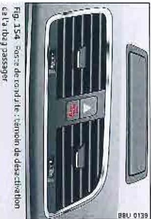
Fig. 154 Poste de conduite : témoin de désactivation de l'airbag passager.
