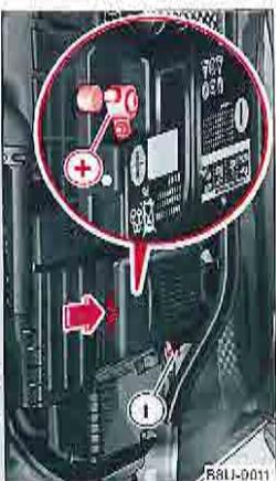
Fig. 171 Comparatif de raccords : raccords de danger et de câble d'aide au démarrage
