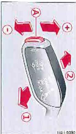
Fig. 89 - Levier de commande : régulateur de vitesse
