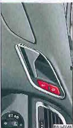
Fig. 29. Porte du véhicule : commande de verrouillage centralisé.
