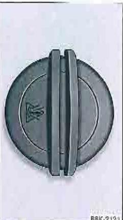
Fig. 169. Compartiment-moteur : repères sur le vase d'expansion de liquide de refroidissement.
