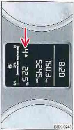
Fig. 12. Combiné d'instruments : indicateur de changement de rapport sur les véhicules sans système d'injection au conducteur.
