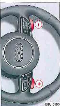
Fig. 93 Volant : passage manuel des rapports avec les palettes\*
