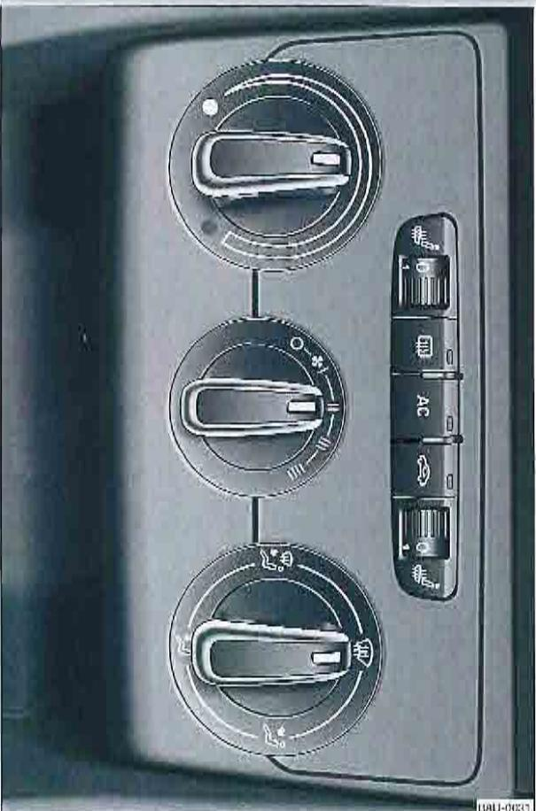
Fig. 78 Commandes du climatiseur manuel
