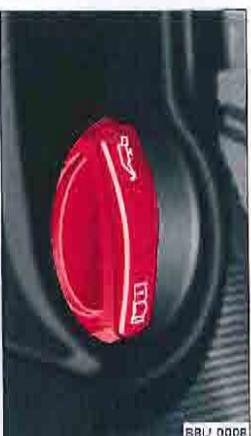
Fig. 168. Compartiment-moteur : bouchon de remplissage de remplissage d'huile-moteur
