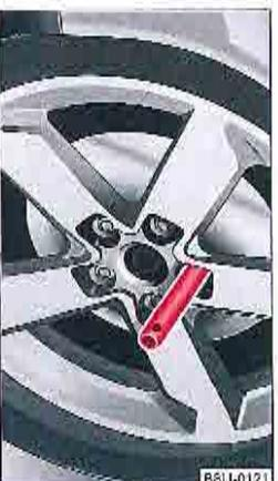
Fig. 192. Changement de roue : axe de montage dans l'orifice supérieur.
