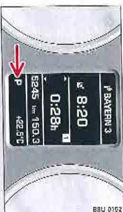
Fig. 90. Combiné d'instruments : position de levier sélecteur
