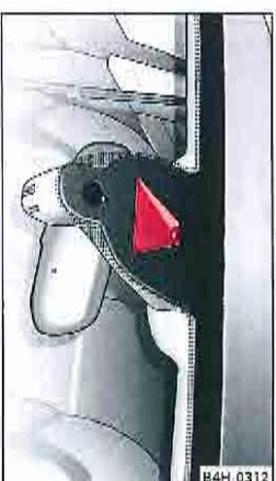
Fig. 22. Pare-brise : caméra de l'affichage des limitations de vitesse
