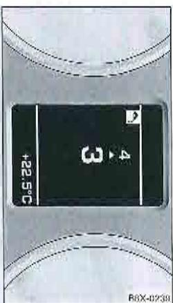
Fig. 17. Combinaison d'instruments : indicateur élargi de changement de rapport sur les véhicules dotés d'un boîtier monochrome
