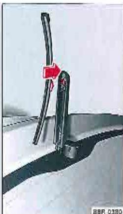
Fig. 53 - Essuie-glace arrière : démontage du bras d'essuie-glace
