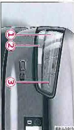
Fig. 203. Arrière du véhicule : ampoules dans le hayon.
