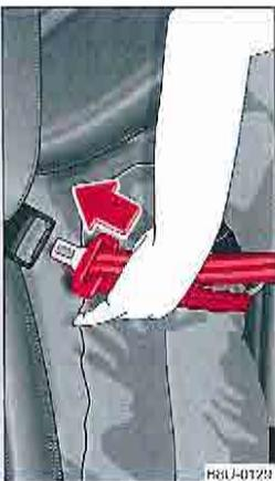
Fig. 140 Siège du conducteur : boîtier de verrouillage et péne.
