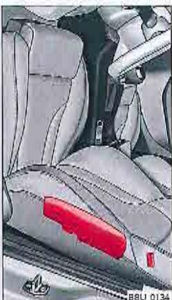
Fig. 149. Emplacement de montage de l'airbag latéral dans le siège conducteur.
