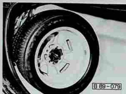
La voiture est équipée d'une roue de secours normale. Pour quelques pays d'exportation, la roue de secours normale est remplacée par une roue d'urgence plate. La roue se trouve à gauche dans le coffre à bagages. Elle est maintenue en place par une vis de fixation en plastique.
