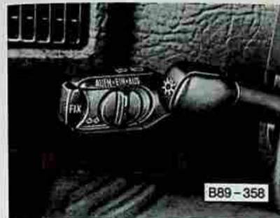
Ce dispositif permet de maintenir constante toute vitesse souhaitée à partir de 35 km/h, tant que la puissance du moteur le permet. Le conducteur peut ainsi lâcher le pied de l'accélérateur, principalement sur de longues distances.
