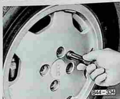
■ A l'aide de la poignée du tournevis, retirez le boulon de roue supérieur (voir figure) et placez-le sur un support propre (enjoliveur, chiffon, papier).
