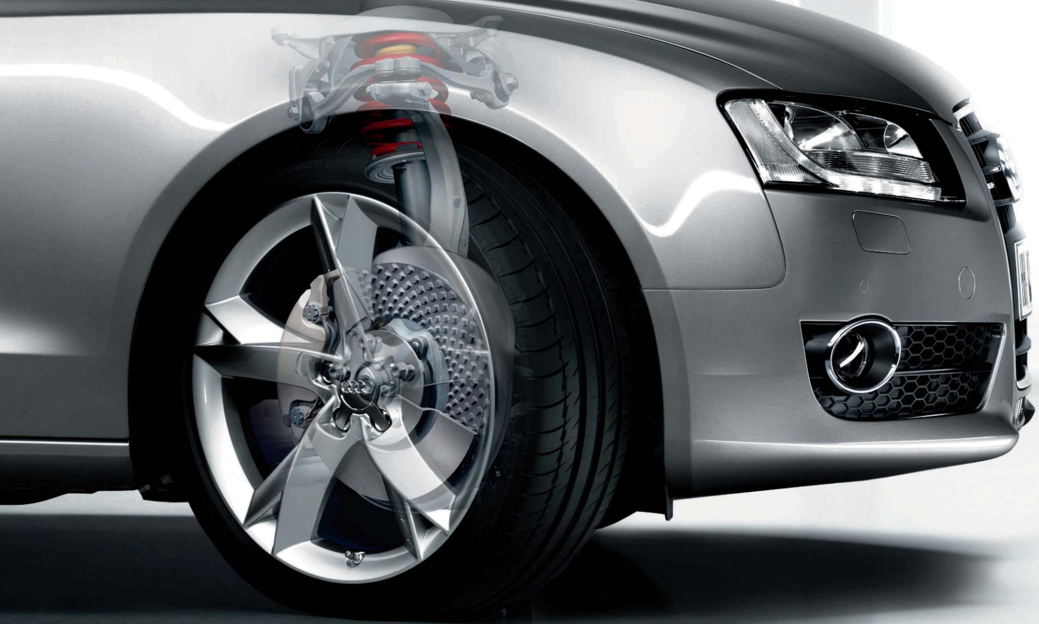
Le système de freinage de l'Audi A5 Coupé bénéficie de la répartition équilibrée des charges sur les essieux : elle est de presque 50:50. Les disques de freins de conception spéciale généreusement dimensionnés réduisent la perte de puissance de freinage en cas de contrainte élevée, ce que l'on appelle le « fading ». La pédale de frein se distingue par son excellente précision de dosage, conférant un plus grand contrôle lors du freinage.
