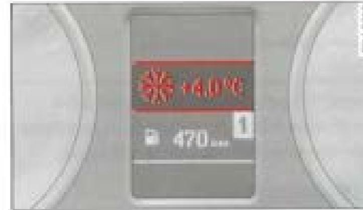
Fig. 12 Écran : indicateur de température extérieure
