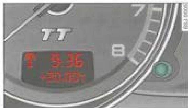
Fig. 5 Vue partielle du combiné d'instruments : zone d'affichage du symbole de réception de l'horloge radiopilotée, de l'heure et de la date.
