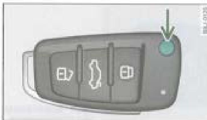
Fig. 33 Clé à radiocommande : bouton de déverrouillage
