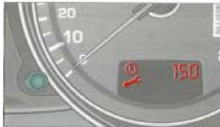
Fig. 8 Vue partielle du combiné d'instruments : indicateur de périodicité d'entretien (jours)
