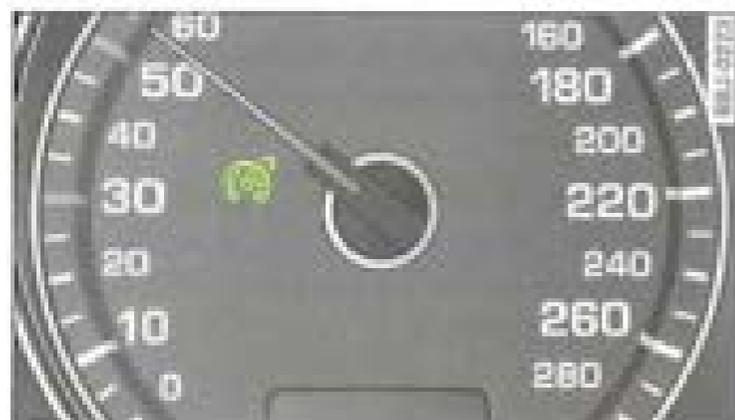
Fig. 96 Témoin du régulateur de vitesse allumé en mode de régulation.
