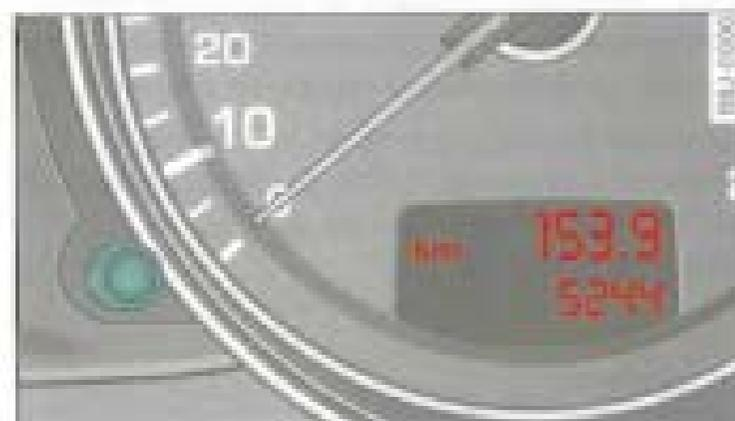
Fig. 6 Vue partielle du combiné d'instruments : compteur kilométrique avec bouton de remise à zéro
