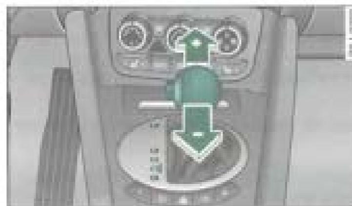
Fig. 103 Console centrale : passage manuel des rapports (tiptronic)
