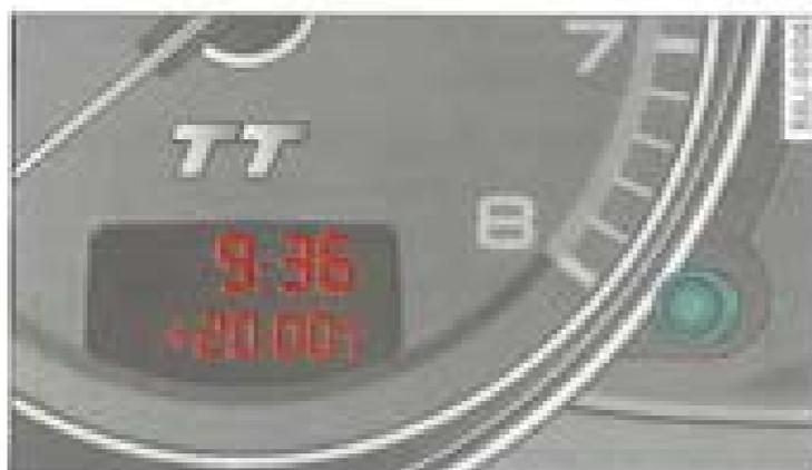
Fig. 4 Vue partielle du combiné d'instruments : zone d'affichage de l'heure et de la température extérieure
