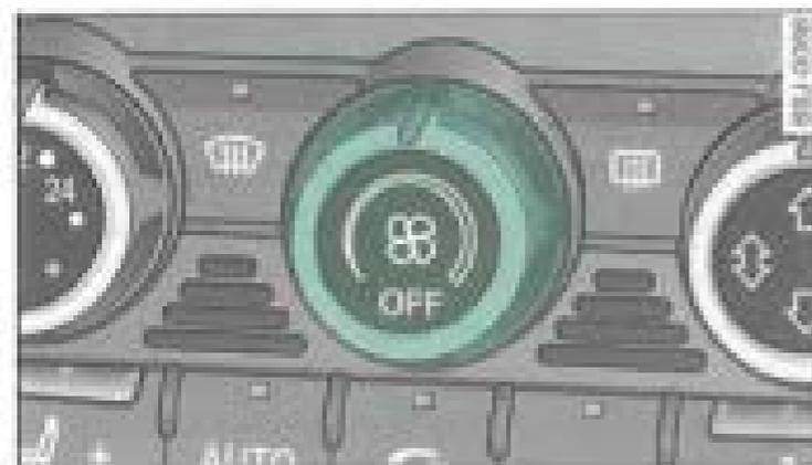
Fig. 87 Bouton rotatif de mise en/hors circuit du climatiseur et du réglage du régime de la soufflante
