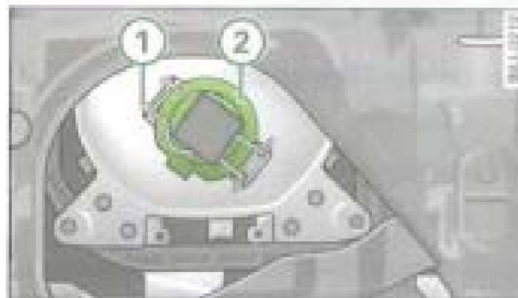
Fig. 187 Boîtier de l'ampoule : Feux de croisement
