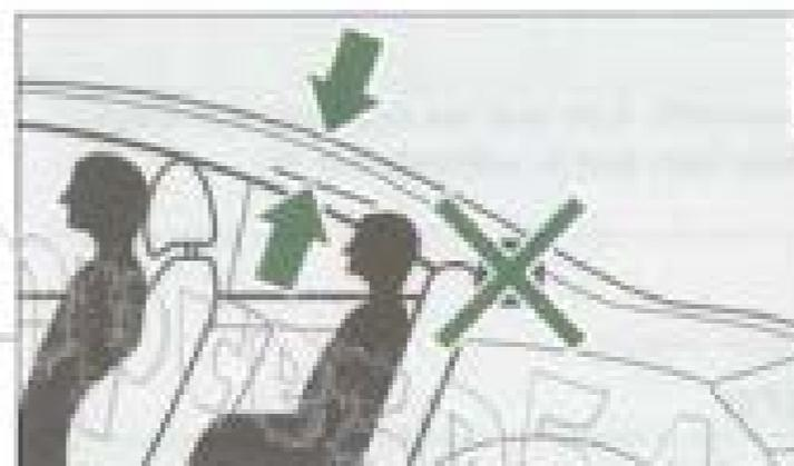
Fig. 74 Position assise correcte sur la banquette arrière
