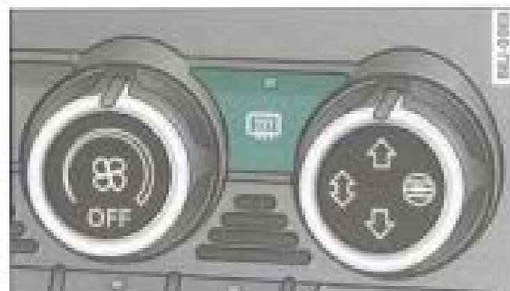
Fig. 90 commande de dégivrage de lunette arrière
