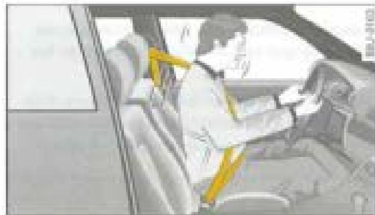
Fig. 112 Conducteur attaché, retenu en cas de freinage brusque par la ceinture correctement positionnée.
