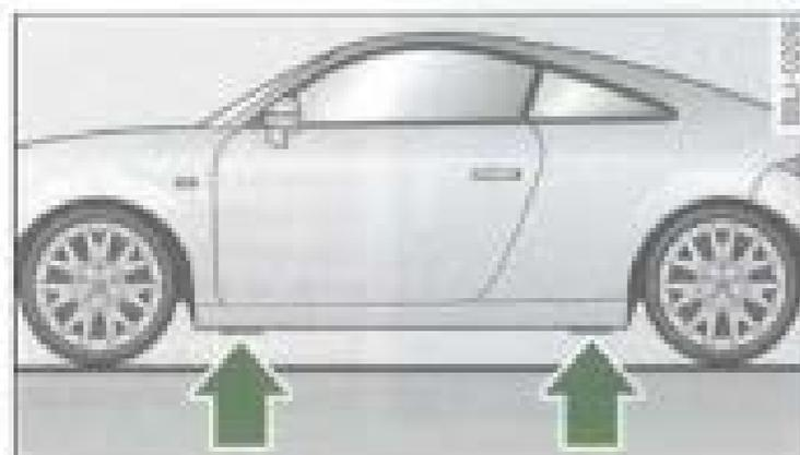
Fig. 172 Changement de roue : points d'appui du cric
