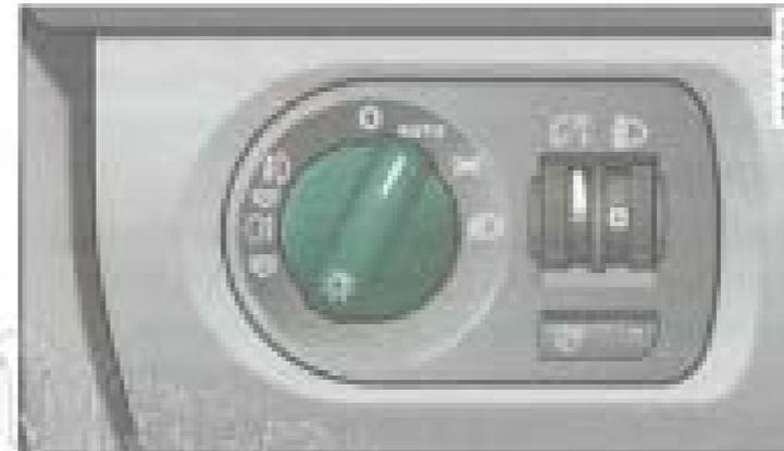
Fig. 50 Vue partielle du tableau de bord : commande d'éclairage rotative
