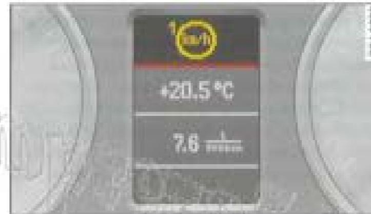
Fig. 27 Écran : Alerte de dépassement de vitesse
