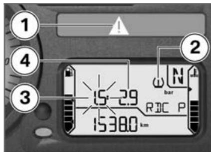
Le symbole d'avertissement **2** signale une pression de gonflage des pneus critique, la pression de gonflage correspondante de la roue avant **3** ou de la roue arrière **4** clignote.
