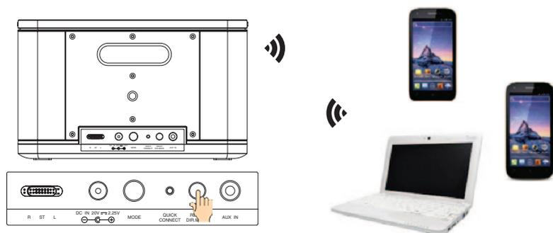
L'indicateur DEL clignote quelques fois et la lumière passe au blanc continu : l'enceinte devient détectable comme un point d'accès Wi-Fi.
