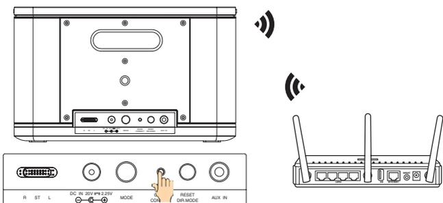
Appuyez sur la touche WPS du routeur et sur la touche de connexion rapide de l'enceinte simultanément. La DEL sur l'enceinte clignote rapidement (blanc). Après environ 10-40 secondes, la DEL Wi-Fi sur l'enceinte devient blanche en continu: L'enceinte est connectée au réseau.
