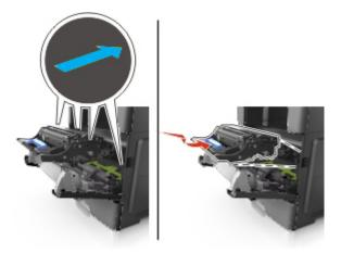
7. Insérez la cartouche de toner dans l'imprimante en alignant les rails latéraux de la cartouche sur les flèches des rails latéraux intérieurs de l'imprimante.
