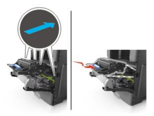
8. Insérez la cartouche de toner en alignant les rails latéraux de la cartouche avec celles situées sur les rails latéraux à l'intérieur de l'imprimante, puis insérez la cartouche dans l'imprimante.
