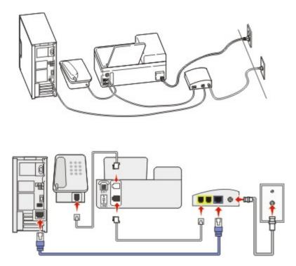
2. Branchez l'autre extrémité du câble sur le port appelé **Phone Line 1** (Ligne téléphonique 1) ou **Phone Port** (Port de téléphone) sur le modem câblé.
