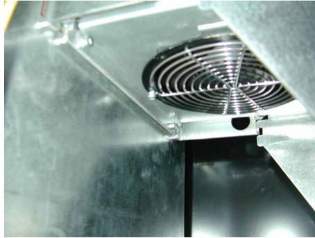
Souffler de l'air comprimé (**essiccata**) du bas vers le haut tout en aspirant à l'aide d'un aspirateur au niveau de la sortie d'air pour récupérer la poussière. **S'il existe un risque de pénétration de la poussière dans les appareils adjacents, les protéger avec une bâche.**
