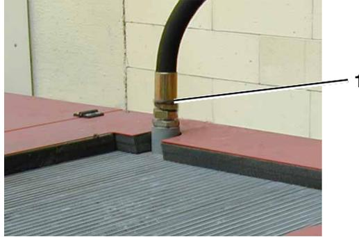
Raccorder le compresseur à l'installation pneumatique de la ligne en utilisant le raccord **1** présent sur le compresseur. Utiliser un tuyau d'un diamètre supérieur ou égal à la sortie du compresseur. Installer, entre le compresseur et le réservoir et entre le réservoir et la ligne, deux robinets à bille d'un débit identique à celui du compresseur.
