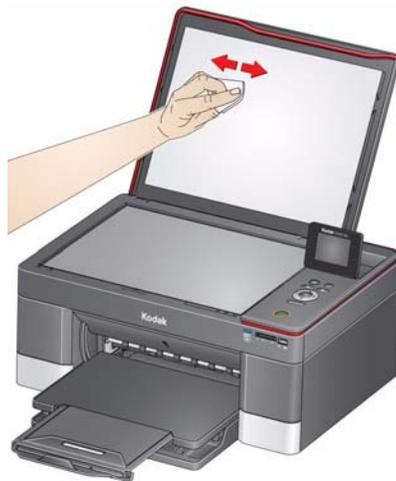
6. Essuyez la surface intérieure du capot à l'aide d'une peau de chamois ou d'un chiffon non pelucheux.
