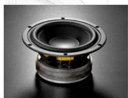
Les deux LD165CR08 (2) sont dotés d'une belle motorisation, d'une membrane papier à suspension périphérique LDS™ (*Low Diffraction Surrounding*) et d'un noyau bagué cuivre réduisant sensiblement la distorsion et la valeur inductive de la bobine mobile.
