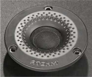
La gamme SIROCCO est dotée du tout nouveau tweeter ATOHM SD20ND04F (classic series) . Cette unité est pourvue d'un moteur néodyme, d'un dôme soie et d'une bobine de 20mm à fil CCAW (alliage de cuivre et d'aluminium). Grâce à la légèreté de
