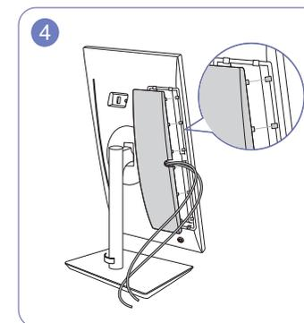
Arrangez les câbles dans la rainure sur le CAPOT ARRIÈRE, puis attachez la PARTIE SECONDAIRE DU CAPOT ARRIÈRE. Lorsque vous fixez la PARTIE SECONDAIRE DU CAPOT ARRIÈRE, commencez par orienter les six nervures de la PARTIE SECONDAIRE DU CAPOT ARRIÈRE vers les orifices de la base du CAPOT ARRIÈRE.
