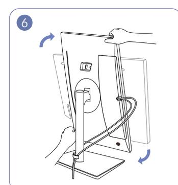
Pivotez l'appareil en position horizontale.
