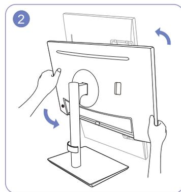
Pivotez l'appareil à la position verticale la plus haute.
