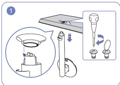
Insérez le connecteur du pied dans le pied, dans le sens indiqué sur l'illustration. Tournez complètement la vis de connexion dans le bas du pied, de façon à ce qu'il soit solidement fixé.
