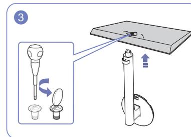
Détachez la vis de fixation au bas de la base de socle puis retirez le col du socle de la base de socle en tirant dans le sens de la flèche, comme indiqué sur l'illustration.
