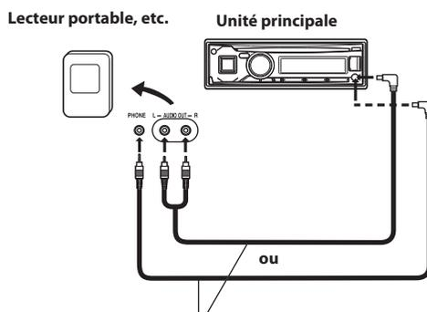
Câble adaptateur en option (connecteur à broche RCA [rouge, blanc] miniprises 3,5ø) ou (miniprises 3,5ø).
