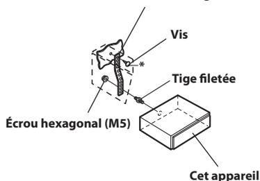
\* Pour la vis\*, procurez-vous une vis appropriée à l'emplacement d'installation du châssis.
