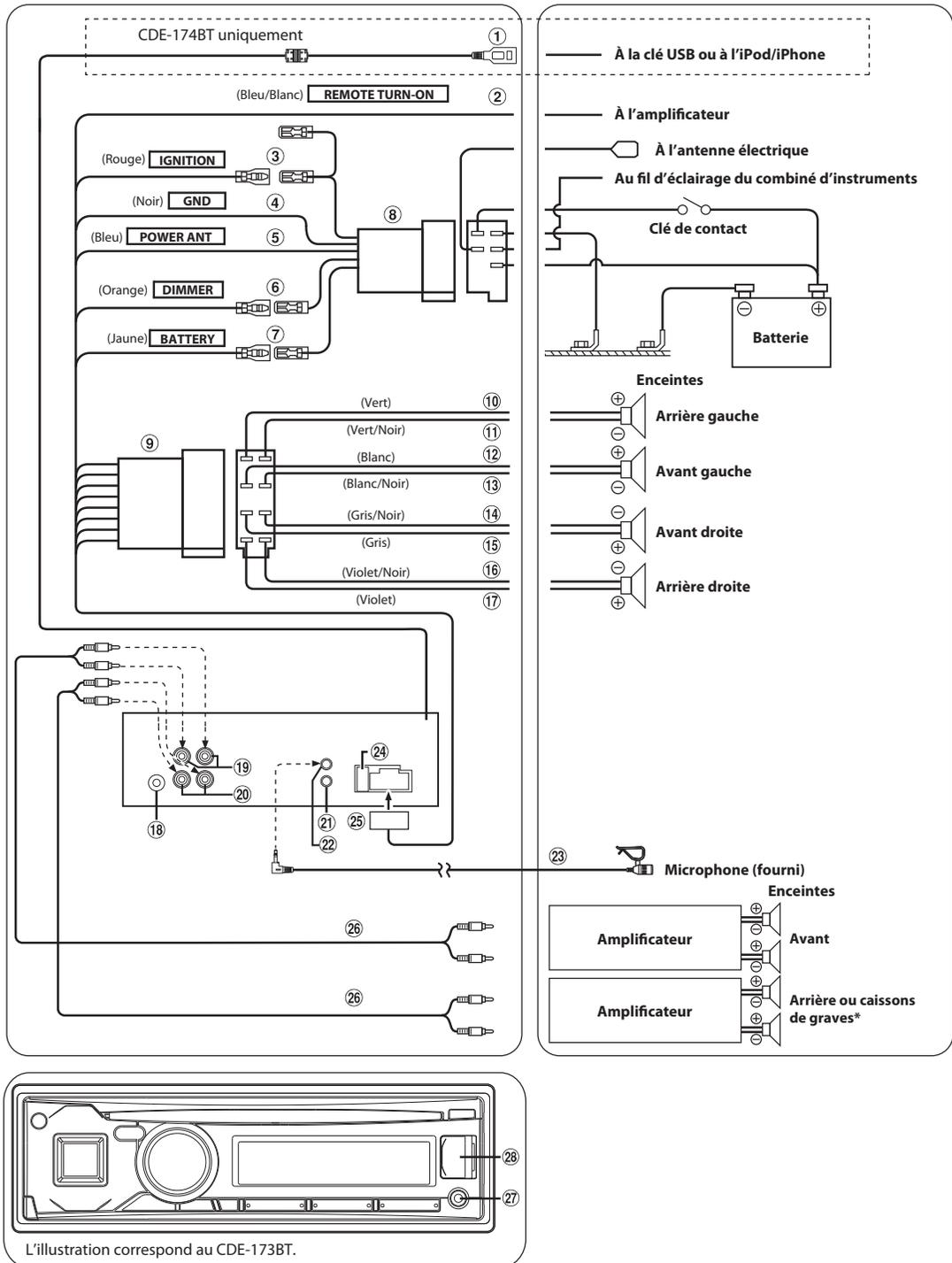
\* Lorsque le caisson de graves est désactivé (OFF) : le son est reproduit dans les enceintes arrière. Lorsque le caisson de graves est activé (ON) : le son est reproduit sur le caisson de graves.
