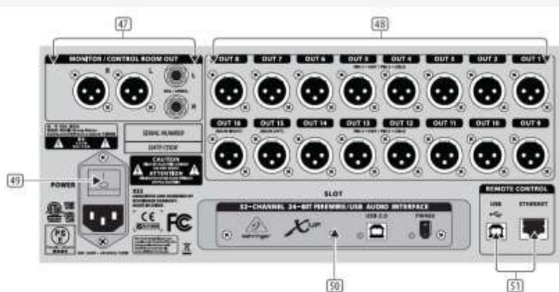
**(47) MONITOR/CONTROL ROOM OUT** - Connectez une paire de moniteurs de studio en utilisant des câbles XLR ou 1/4".
