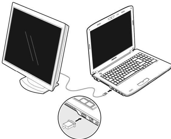
Si votre appareil (téléviseur ou moniteur) dispose d'une entrée adaptée, vous pouvez aussi utiliser la prise HDMI numérique (High Definition Multimedia Interface) (15) pour le transfert de signaux vidéo et audio.
