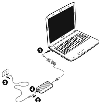
L'adaptateur dispose d'un interrupteur de marche/arrêt. Si cet interrupteur se trouve sur la position ARRÊT (0), l'adaptateur ne consomme pas de courant et l'ordinateur portable n'est pas alimenté.
