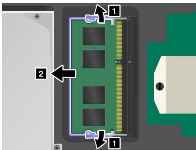
6. Repérez l'encoche sur le côté du bord de contact du module de mémoire que vous installez.
