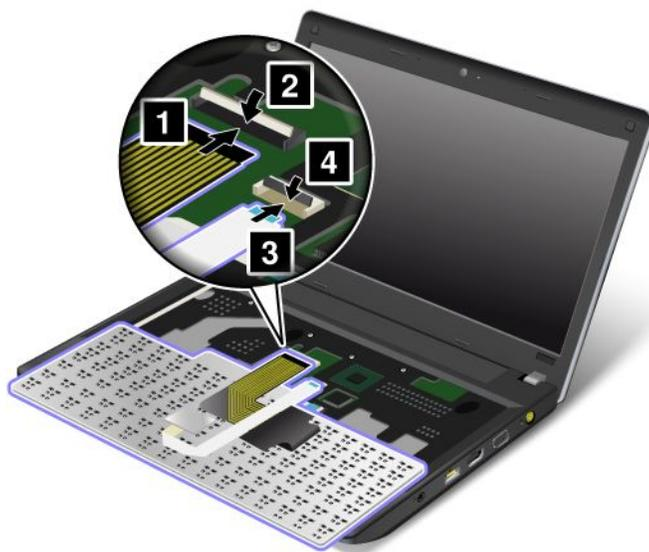
2. Insérez le clavier. Assurez-vous que les bords du clavier, à l'arrière, se trouvent sous le cadre.
