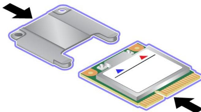
9. Alignez le bord du contact de la nouvelle carte mini-PCI Express (modèle court) sur le contact correspondant **1**. Faites pivoter la carte jusqu'à ce qu'elle s'enclenche. Fixez la carte à l'aide de la vis **2**.
