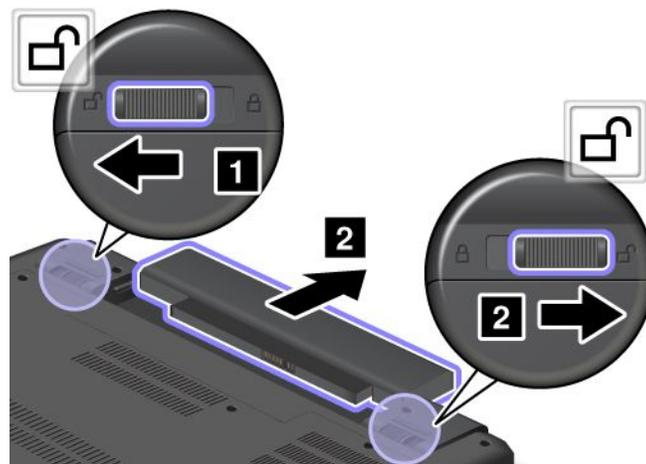
4. Insérez une batterie complètement chargée jusqu'à ce qu'un déclic de mise en place se fasse entendre **1** comme indiqué dans l'illustration, puis faites glisser le loquet de la batterie jusqu'à la position verrouillée **2**.
