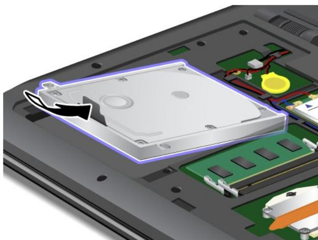
8. Faites glisser l'unité de disque dur ou l'unité SSD fermement dans le connecteur **1**, puis réinstallez les vis **2**.
