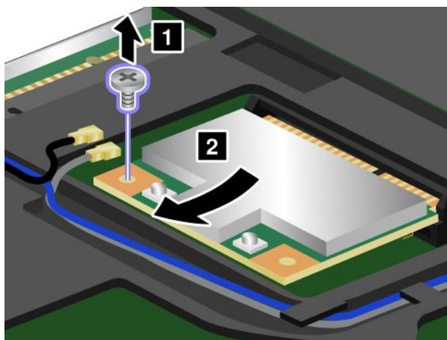
7. Alignez le bord du contact de la nouvelle carte mini-PCI Express sur le contact correspondant **1**. Faites pivoter la carte jusqu'à ce qu'elle s'enclenche. Fixez la carte à l'aide de la vis **2**.
