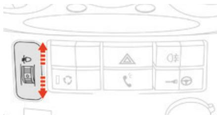
En fonction de la charge et du nombre de passagers dans le véhicule, les faisceaux de votre E-MEHARI peuvent être réglés afin de ne pas gêner les autres conducteurs. Votre E-MEHARI est équipée d'une molette de réglage de la hauteur des feux.
