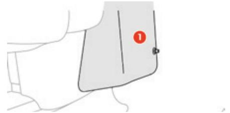
Déposer l'écrou de la trappe d'accès (1) située sous le vide poche passager.
