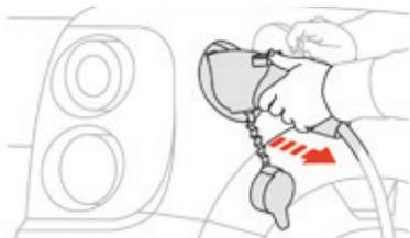
Déverrouillez votre véhicule et débranchez la prise de charge.
