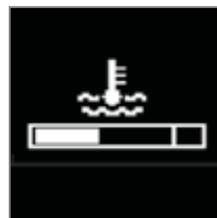
Moteur tournant, il indique la température du liquide de refroidissement (voir chapitre «Indicateur de température du liquide de refroidissement»).
