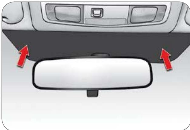
Le pare-brise athermique comporte une zone non réfléchissante située au-dessus de la base du rétroviseur intérieur. Elle est destinée à l'apposition des cartes de télépéage et/ou de parking.
