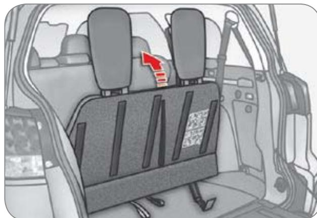
7. Soulevez et poussez l'ensemble de la banquette vers l'avant, jusqu'au verrouillage.
