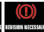
L'allumage de ces deux témoins, couplés aux affichages d'avertissement dans l'écran du combiné, indique un dysfonctionnement du répartiteur électronique pouvant provoquer une perte de contrôle du véhicule au freinage.
