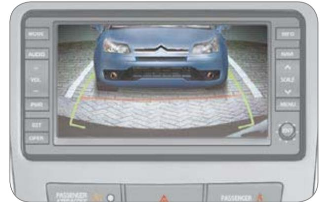
Liée à l'option navigation, une caméra de recul s'active automatiquement au passage de la marche arrière.
