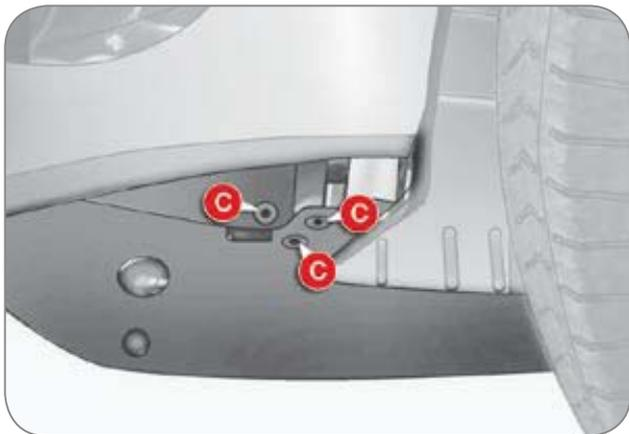
☞ Retirez à l'aide d'un tournevis, les trois clips **C** situés sous le pare-chocs.
