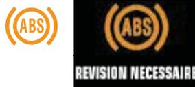
L'allumage de ce témoin, accompagné de l'affichage dans l'écran du combiné, indique un dysfonctionnement du système d'antiblocage pouvant provoquer une perte de contrôle du véhicule au freinage.
