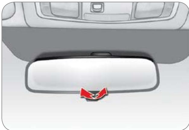
Ajustez le rétroviseur en le déplaçant vers le haut, le bas, et/ou vers la gauche, la droite.
