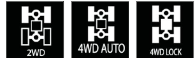
Le mode de transmission est affiché sous forme d'affichage intermittent sur l'afficheur du combiné lorsque le mode de transmission est sélectionné.
