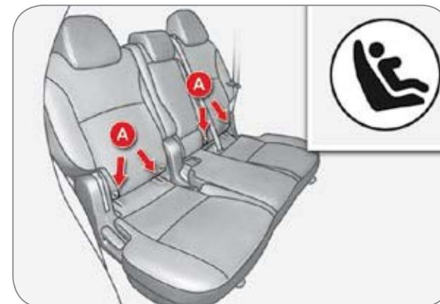
Deux anneaux **A**, situés entre le dossier et l'assise du siège du véhicule permettent de fixer un siège enfants.
