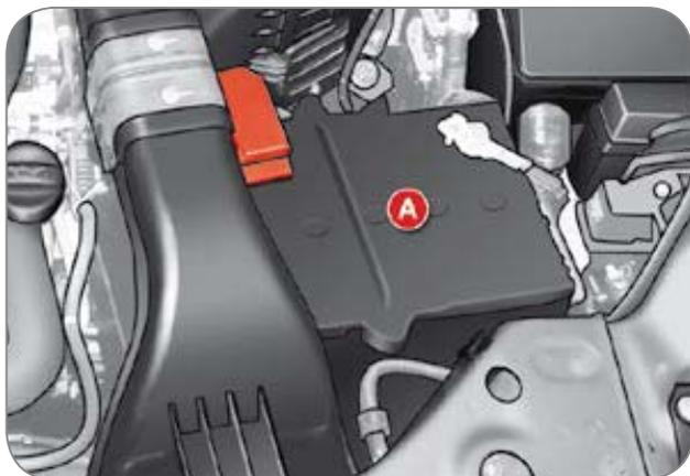
La batterie **A** est située sous le capot moteur à gauche.
