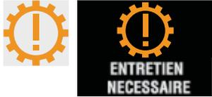
Contact mis, l'allumage de ce témoin, accompagné de vibrations dans les pédales et du message «**Entretien nécessaire**» sur l'afficheur du combiné, indique un dysfonctionnement de la boîte de vitesses.
