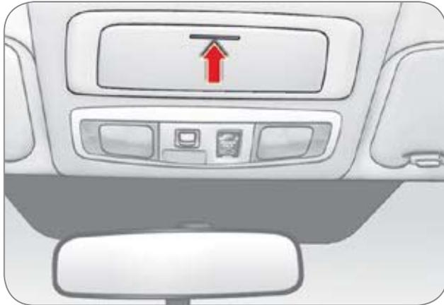
Appuyez sur le couvercle pour l'ouvrir. Pour le refermer, poussez le couvercle jusqu'à ce qu'il se verrouille.
