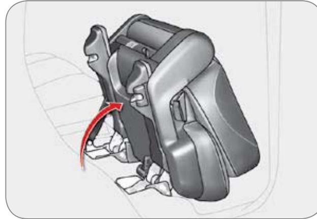
Le passager a accès à la troisième rangée de sièges en basculant un siège de la deuxième rangée.
