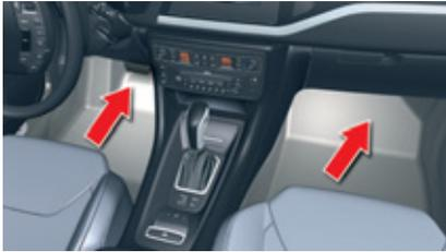
À l'avant, à l'ouverture d'une porte, il permet d'éclairer l'intérieur du véhicule.
