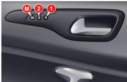
Système prenant en compte les réglages du siège conducteur et de la climatisation. Il vous permet de mémoriser jusqu'à deux positions à l'aide des touches sur le côté du siège conducteur.
