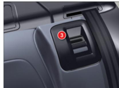
Le voyant rouge de la commande 3 ne doit plus être visible sinon poussez le siège à fond.
