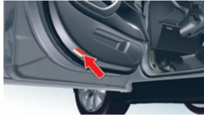
Porte ouverte, il permet d'éclairer le sol à l'extérieur du véhicule.
