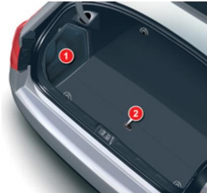
1. Emplacement de la batterie pour les véhicules équipés du moteur V6 HDi.
