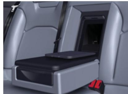
Une trappe dans le dossier situé derrière l'accoudoir permet le transport d'objets longs.
