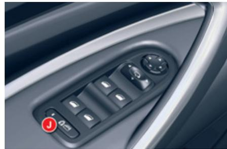
Elle permet de neutraliser les commandes arrière des lève-vitres et l'ouverture des portes arrière de l'intérieur. La sécurité électrique est activée par une impulsion sur la commande J.
