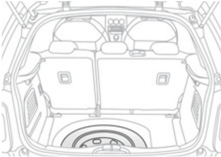
La roue de secours est installée dans le coffre sous le plancher.
