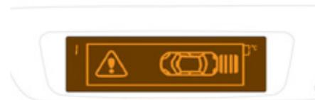
Système constitué de quatre capteurs de proximité, installés dans le pare-chocs arrière. Il détecte tout obstacle (personne, véhicule, arbre, barrière...) derrière le véhicule, sauf les obstacles situés juste sous le pare-chocs.
