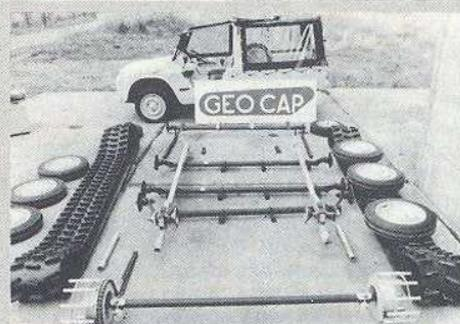
Le dernier essieu (6) équipé de roues de 12'' est également en « roue tirée ». Le biellette A permet, à l'aide d'un tirant (non monté), d'obtenir un préréglage de l'assiette en fonction de la charge transportée. Si la voiture est exclusivement utilisée en chenillette, on peut déposer les bras de suspension arrière B ; gain de place et de poids.
