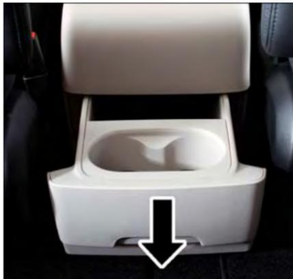
3. Retirez la doublure du compartiment de rangement de la console pour accéder à l'écrou de commande du treuil de la roue de secours.
