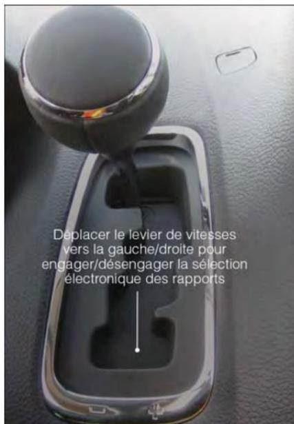
Déplacer le levier de vitesses vers la gauche/droite pour engager/désengager la sélection électronique des rapports
