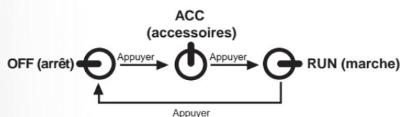
**NOTA :** Si le commutateur d'allumage est laissé à la position ACC (accessoires) ou ON/RUN (marche) (moteur arrêté) et que la transmission est à la position P, le système s'arrêtera automatiquement après 30 minutes d'inactivité et le commutateur d'allumage passera à la position OFF (arrêt).
