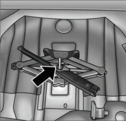
6. Détachez le cric articulé et la clé à écrous de la roue de secours. Tournez la vis du cric vers la gauche pour desserrer la clé à écrous et détachez-la du cric.
