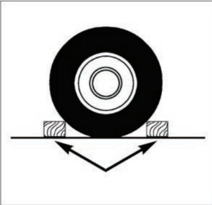
Calez l'avant et l'arrière de la roue diagonalement opposée à la position de levage. Par exemple, si vous changez le pneu avant droit, bloquez la roue arrière gauche.
