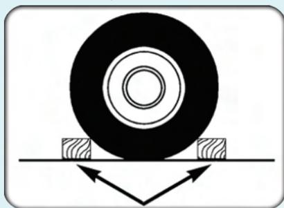
**NOTA :** Les occupants ne doivent pas demeurer dans le véhicule lorsque ce dernier est soulevé par un cric.
