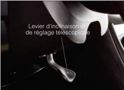
Levier d'inclinaison et de réglage télescopique
