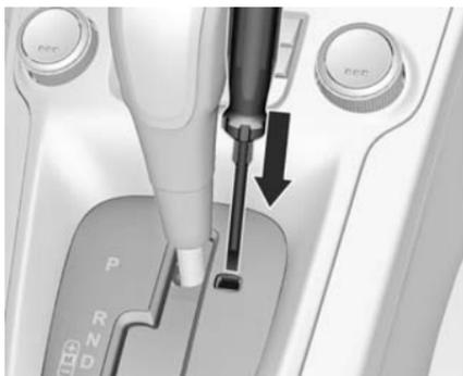
3. Introduire un tournevis aussi loin que possible dans l'ouverture et déplacer le levier sélecteur de la position **P**. Si le levier sélecteur est à nouveau ramené en position **P**, il sera à nouveau bloqué dans cette position. Faire corriger la cause de la coupure de courant par un atelier.
