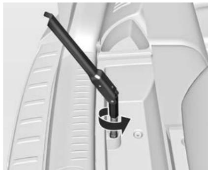
5. Tourner le boulon hexagonal dans le sens inverse des aiguilles d'une montre jusqu'à rencontrer une résistance notable.
