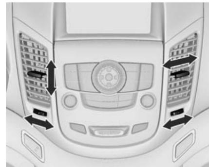
Tourner la molette pour ouvrir ou fermer le volet d'aération ou pour régler le débit d'air.
