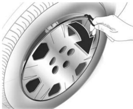
1. Dégager et retirer les capuchons des écrous de roue à l'aide d'un tournevis. Enlever l'enjoliveur à l'aide du crochet. Outillage de bord ⇨ 237.
