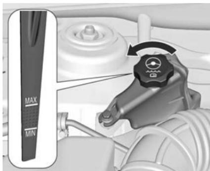
Ouvrir le bouchon et l'enlever. Essuyer la jauge et tourner le bouchon dans le réservoir. Ouvrir à nouveau le bouchon et relever le niveau de liquide de direction assistée.
