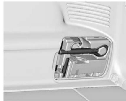
Les outils se trouvent avec le kit de réparation des pneus sur la droite du coffre sous un couvercle.
