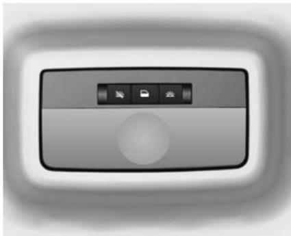
À la montée et à la descente du véhicule, les plafonniers s'allument automatiquement et s'éteignent au bout d'un bref instant. Ils s'allument un bref instant même après le retrait de la clé de contact.
