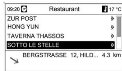
Sous la liste, des informations détaillées sur le point d'intérêt actuellement repéré sont affichées : la direction approximative vers le point d'intérêt, l'adresse et la distance.
