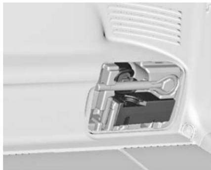
Le kit de réparation des pneus se trouve dans un espace de rangement sous le recouvrement de plancher du coffre. Ouvrir le compartiment de rangement ➔ 237
