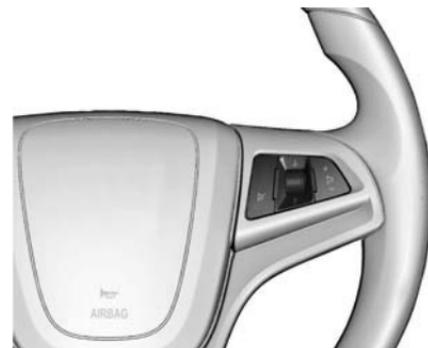
Les fonctions de l'Infotainment System peuvent être commandées à partir du volant.
