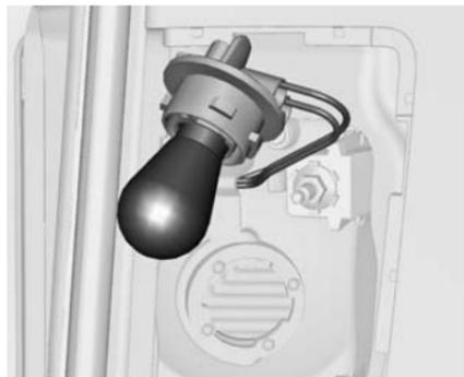
3. Enlever le support d'ampoule. Pousser légèrement l'ampoule dans la douille, la tourner dans le sens antihoraire, l'enlever et remplacer l'ampoule.
