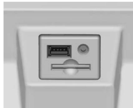
Les appareils connectés au port USB sont commandés par les commandes et menus de l'Infotainment System.
