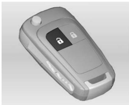
Un déverrouillage du véhicule en enfonçant le bouton
