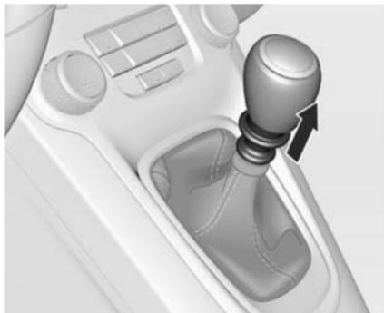
Marche arrière : le véhicule étant à l'arrêt, débrayer puis soulever la bague du levier sélecteur et engager le rapport.
