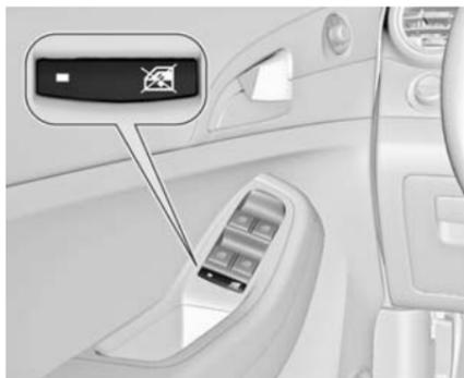
Appuyer sur le commutateur
