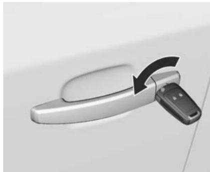
Déverrouiller manuellement la porte du conducteur en tournant la clé dans la serrure. Mettre le contact et appuyer sur le bouton de verrouillage central
