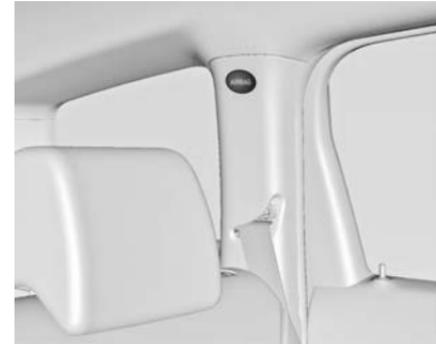
Le système d'airbags rideaux se compose d'un airbag de cadre de toit, de chaque côté du véhicule. Ceci est reconnaissable à l'inscription **AIRBAG** sur les montants de toit.
