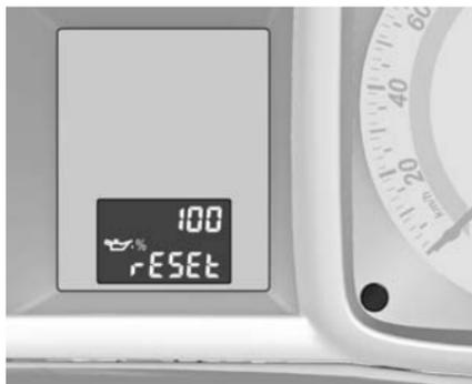
Appuyer sur le bouton de remise à zéro pendant environ 5 secondes jusqu'à ce que la durée de vie restante de l'huile moteur soit affichée. Relâcher le bouton de remise à zéro puis appuyer de nouveau pendant quelques secondes pour remettre à zéro le système d'indication de durée de vie de l'huile moteur.
