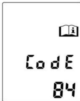
Les messages du véhicule sont affichés sous forme de codes chiffrés.
