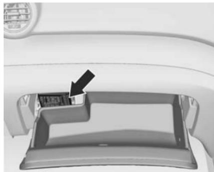
Dans les véhicules avec direction à droite, la boîte à fusibles se trouve dans la boîte à gants.
