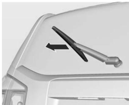
Soulever le bras d'essuie-glace. Pousser sur le balais d'essuie-glace en l'inclinant légèrement par rapport au bras d'essuie-glace vers le bas jusqu'à ce qu'il se désengage.
