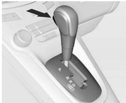
**P** = Position de stationnement : les roues sont bloquées. À n'engager que si le véhicule est à l'arrêt, frein de stationnement serré
