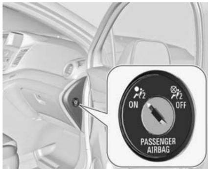
On peut désactiver le système d'airbag passager avant à l'aide d'un commutateur à clé placé à droite du tableau de bord.
