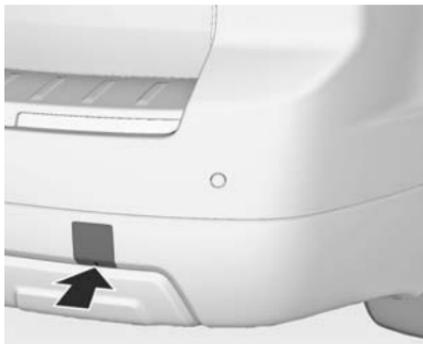
Appuyer sur le capuchon jusqu'à ce qu'il se désenclenche avec son audible et le retirer avec précaution.
