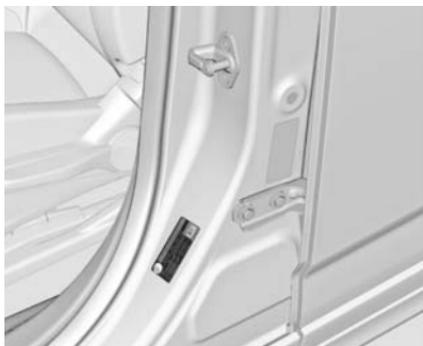
Pression de gonflage ⇨ 274 et sur l'étiquette apposée sur le cadre de porte avant gauche.
