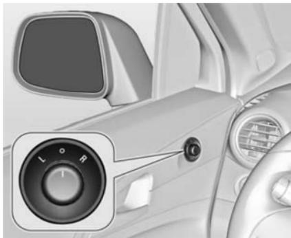
Sélectionner le rétroviseur extérieur souhaité en tournant la commande à gauche (**L**) ou à droite (**R**).
