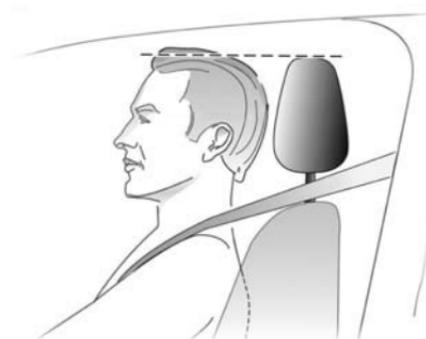
Le bord supérieur de l'appui-tête doit toujours être au niveau du haut de la tête. Si cela s'avérait impossible pour des personnes de très grande taille, l'appui-tête doit être réglé sur la position la plus haute. Pour des personnes de très petite taille, régler l'appui-tête sur la position la plus basse.
