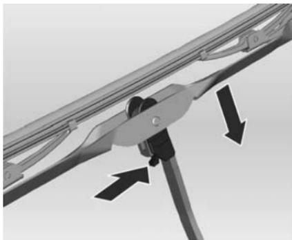
Lever le balais d'essuie-glace, appuyer sur le levier de déverrouillage et faire glisser le balais d'essuie-glace vers le bas pour le désengager et le retirer.
