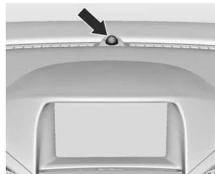
La LED d'état est intégrée dans le capteur sur le haut du tableau de bord.
