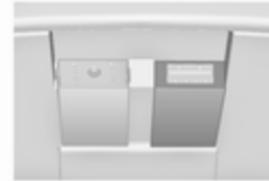
Une prise USB pour la connexion de sources audio externes se trouve sous le couvercle de la console centrale.
