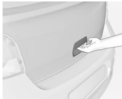
Après le déverrouillage, appuyer sur le bouton sous la poignée ou sous la moulure de hayon et ouvrir le hayon.
