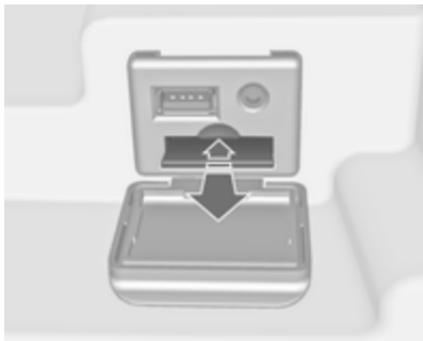
Appuyer sur la carte SD insérée pour la déverrouiller, et ensuite la retirer avec précaution de la fente.
