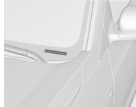
Le numéro d'identification du véhicule est également visible à travers le pare-brise.
