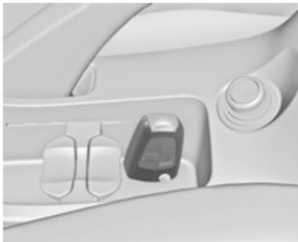
Ouvrir le couvercle dans le fond du porte-gobelet dans la console centrale. Déplier la clé électronique et l'insérer dans le barillet.
