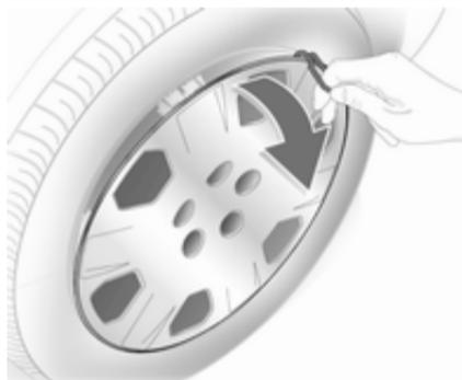
1. Dégager et retirer les capuchons des écrous de roue à l'aide d'un tournevis. Enlever l'enjoliveur à
