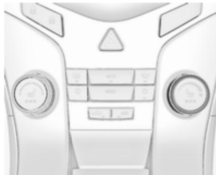
Tourner le bouton rotatif droit. La vitesse de soufflerie sélectionnée est indiquée par un numéro sur l'affichage.
