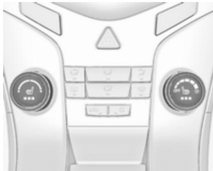
Activer le chauffage de siège avant en appuyant sur le bouton
