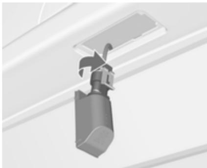
3. Faire tourner la douille de l'ampoule dans le sens antihoraire pour la désencliqueter.
