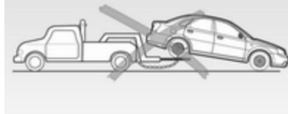
Lors d'un remorquage par 2 roues, soulever les roues motrices avant et remorquer avec les roues avant verrouillées.
