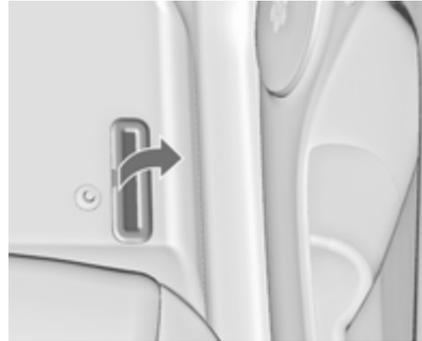
Le numéro d'identification du véhicule se trouve sur le plancher du véhicule, côté droit, sous un cache entre la porte avant et le siège.
