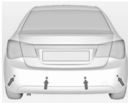
L'aide au stationnement facilite les manœuvres en mesurant la distance entre le véhicule et les obstacles arrière et en émettant des signaux sonores. C'est toutefois le conducteur qui reste pleinement responsable de la manœuvre de stationnement.
