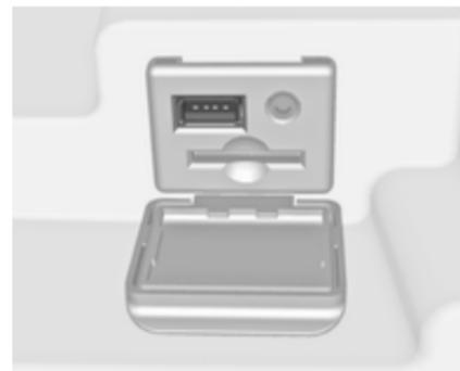
Une prise USB pour la connexion de sources audio externes se trouve sous le couvercle de la console centrale.
