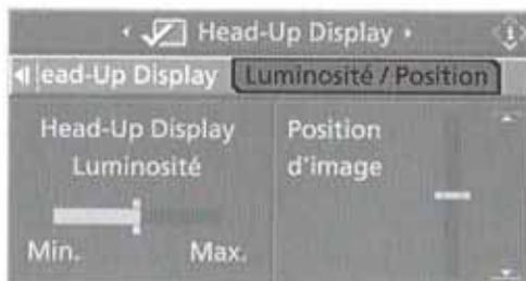
7. Le cas échéant, déplacer le Contrôleur vers la gauche ou la droite pour sélectionner « Head-Up Display Luminosité » ou « Position d'image ».
