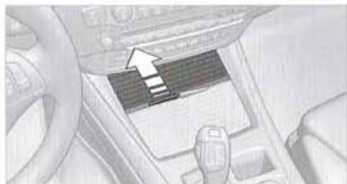
Pour l'ouvrir, pousser le recouvrement vers l'avant.
