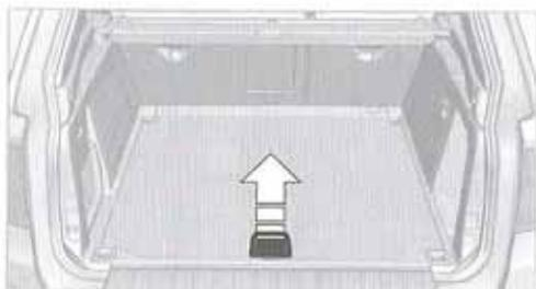
Vous trouverez l'outillage de bord sous la trappe du plancher du compartiment à bagages.
