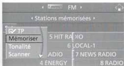
5. Tourner le Controller jusqu'à ce que l'emplacement mémoire souhaité soit sélectionné. Le numéro de l'emplacement mémoire est affiché à côté du nom et de la fréquence de la station.
