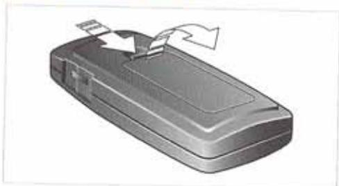
1. Appuyer sur la languette d'encliquetage et enlever le couvercle.
