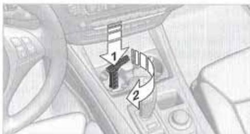
3. Le cas échéant, déverrouiller la serrure\* avec la clé intégrée dans la télécommande, voir page 26 et la sortir.
