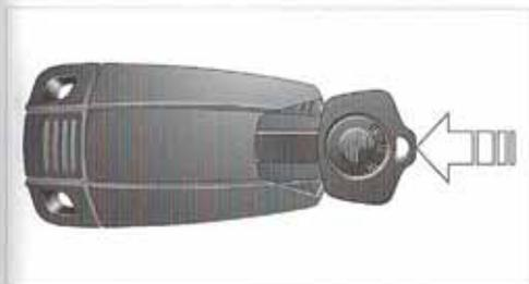
Avant de l'utiliser, glisser la clé de secours dans l'adaptateur.
