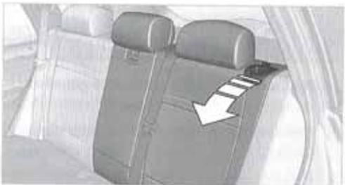
Engager les doigts dans la cuvette et tirer vers l'avant.
