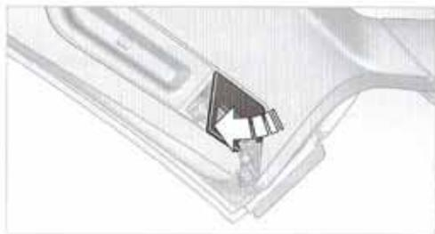
6. Mettre le feu d'éclairage du compartiment à bagages en place et le faire encliqueter, voir la flèche.
