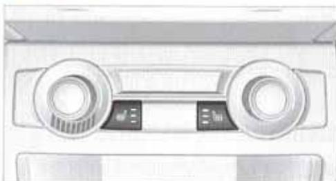
Fonctionnement comme décrit pour le chauffage des sièges avant, sans réglage de répartition du chauffage.
