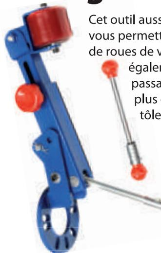
Cet outil aussi appelé "Roller fender" va vous permettre de redresser les passages de roues de votre véhicule. Il peut également servir à élargir ces passages pour accueillir des roues plus grandes sans venir frotter la tôle.
