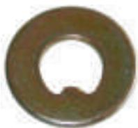
**1 Rondelle sur fusée pour roulement arrière**
