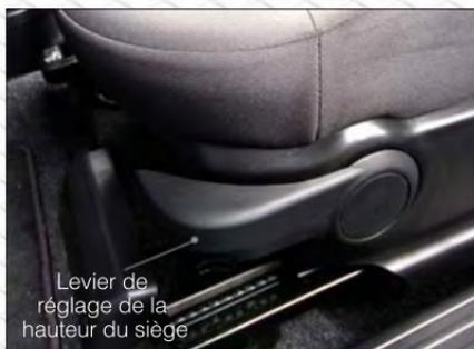
Levier de réglage de la hauteur du siège
