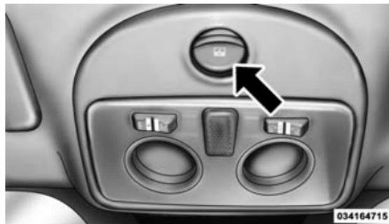
Commutateur de toit ouvrant à commande électrique
