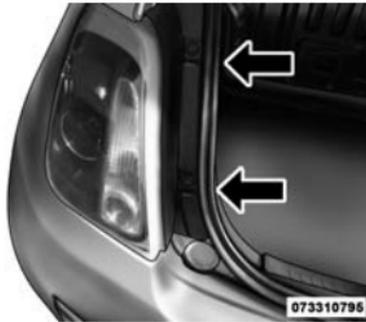
Vis du bloc optique arrière
