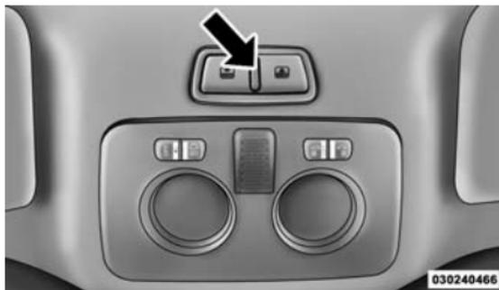
**Commutateur de capote à commande électrique**
