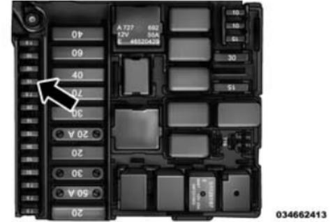
Emplacement du fusible de la prise de courant sous le capot
