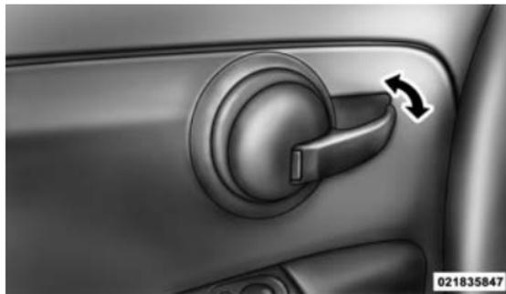
Poignée de verrouillage à commande électrique de la portière du conducteur
