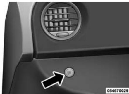
Commutateur ESC Off (désactivation de la commande de stabilité électronique) (transmission manuelle)
