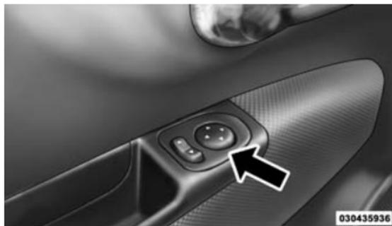
Commutateurs des rétroviseurs extérieurs à commande électrique
