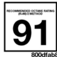
Ce moteur est conçu en conformité avec les règlements antipollution et offre une économie de carburant et un rendement satisfaisants avec de l'essence sans plomb ordinaire de haute qualité d'un indice d'octane de 87 minimum. Pour un rendement et une économie optimaux, l'utilisation d'un carburant avec un indice d'octane de 91 ou plus est recommandée.
