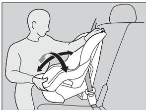
6. S'assurer que le dispositif de retenue pour enfant est fixé de façon sécuritaire en tentant de le basculer d'avant en arrière et d'un côté à l'autre; peu de mouvement doit être ressenti.
