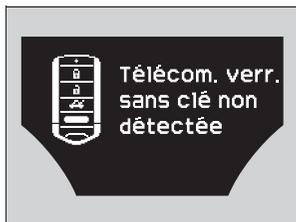
Les rappels sonores peuvent retentir à l'intérieur et/ou à l'extérieur du véhicule afin de rappeler au conducteur que la télécommande d'accès sans clé est à l'extérieur du véhicule. Si le rappel sonore continue de retentir même une fois que la télécommande est rapportée à l'intérieur du véhicule, placer la télécommande dans sa portée opérationnelle.
