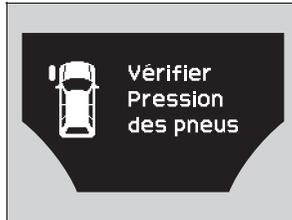
**Vérifier Pression des pneus** s'affiche lorsque la pression de gonflage d'un pneu est considérablement basse. L'emplacement spécifique du pneu s'affiche sur l'écran.
