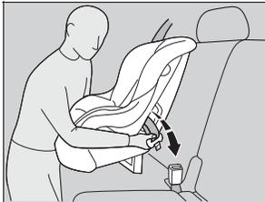
1. Placer le siège de sécurité pour enfant sur le siège du véhicule.
