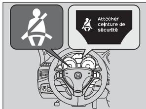
Le véhicule surveille l'utilisation des ceintures de sécurité avant. Si le mode d'alimentation passe à MARCHE avant que la ceinture de sécurité du conducteur ne soit bouclée, un signal sonore retentira et le témoin clignotera. Si le conducteur ne boucle pas la ceinture avant l'arrêt du signal sonore, le témoin restera allumé.
