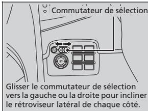
Lorsque la fonction d'inclinaison est activée, l'un des rétroviseurs latéraux s'incline automatiquement lorsque le levier de vitesses passe à la position de marche arrière **R** ; cela améliore la vue rapprochée du côté choisi lorsque le véhicule recule. Le rétroviseur revient automatiquement à sa position d'origine lorsqu'on annule la marche arrière **R** en déplaçant le levier vers une autre position.
