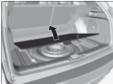
1. Ouvrir le couvercle de plancher du compartiment à bagages.
