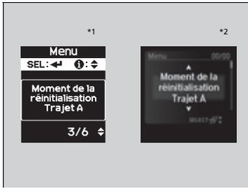
4. Appuyer sur le bouton / jusqu'à ce que **Moment de la réinitialisation Trajet A** apparaisse sur l'affichage, puis appuyer sur le bouton **SEL/RESET** (sélectionner/réinitialiser).
