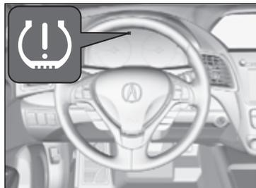
Surveille la pression des pneus pendant la conduite. Si la pression des pneus du véhicule s'abaisse considérablement, le témoin de basse pression de pneu/TPMS s'allume et un message apparaît sur l'affichage multifonctions.
