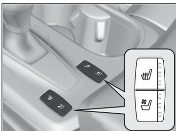
Appuyer sur le bouton de chauffe-siège ou de ventilation de siège :
