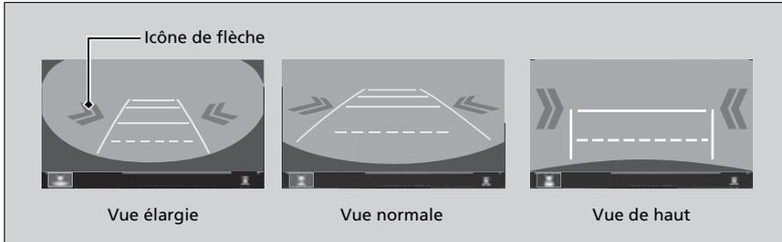
Une icône de flèche apparaît sur l'écran d'affichage audio/d'information, du côté où un véhicule approche.
