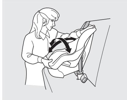
5. Pousser et tirer le siège de sécurité pour enfant d'avant en arrière et d'un côté à l'autre pour confirmer qu'il reste parfaitement en place lors de manœuvres normales. Si le siège de sécurité pour enfant n'est pas assez solide, détacher la ceinture, la laisser s'enrouler complètement puis répéter ces étapes.
