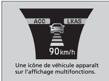
Si un véhicule entre dans le rayon d'action ou coupe devant votre véhicule alors que sa vitesse est inférieure à la vitesse de consigne de votre véhicule et que le radar et la caméra le détectent, votre véhicule commencera à ralentir.
