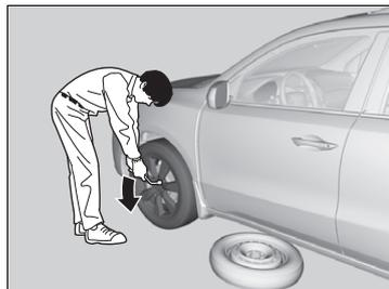
**10.** Desserrer chaque écrou de roue d'environ un tour en utilisant la clé pour écrou de roue.
