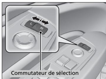
Si ce bouton est activé, les rétroviseurs extérieurs s'inclinent automatiquement si le bouton **R** est tiré à nouveau; cela améliore la vue rapprochée sur le côté sélectionné du véhicule en reculant. Le rétroviseur revient automatiquement à sa position d'origine lorsqu'on quitte la marche arrière **R**.
