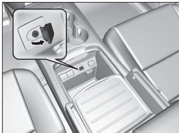
Utiliser la prise pour connecter des appareils audio standards.
