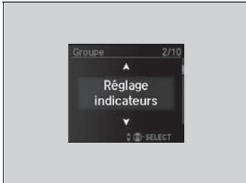
2. Faire tourner la commande multifonctions sur le volant de direction jusqu'à ce que **Réglage indicateurs** apparaisse sur l'affichage.
