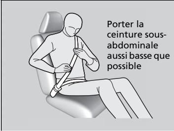
3. Faire passer la partie sous-abdominale de la ceinture le plus bas possible sur les hanches, puis tirer sur la partie épaulière de la ceinture pour que la partie sous-abdominale soit bien ajustée. De cette façon, les os massifs au niveau du bassin amortiront la force d'une collision et réduiront les risques de blessures internes.
