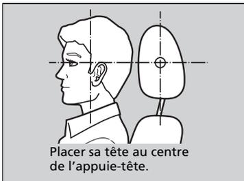
Les appuie-tête sont plus efficaces pour une protection contre le coup de fouet cervical et autres blessures infligées par une collision avec choc arrière lorsque le milieu de la tête de l'occupant est appuyé au centre de l'appuie-tête. Le haut des oreilles de l'occupant doit être au niveau du centre de la hauteur de l'appuie-tête.
