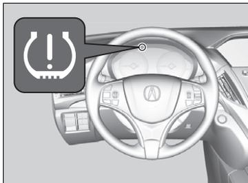
Surveille la pression de gonflage des pneus pendant la conduite. Si la pression de gonflage des pneus du véhicule s'abaisse considérablement, le témoin de basse pression de gonflage des pneus/TPMS s'allume et un message apparaît sur l'affichage multifonctions intelligent.
