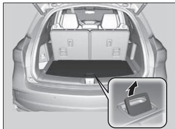
Pour ouvrir le couvercle du compartiment à bagages sous le plancher, tirer sur la poignée.
