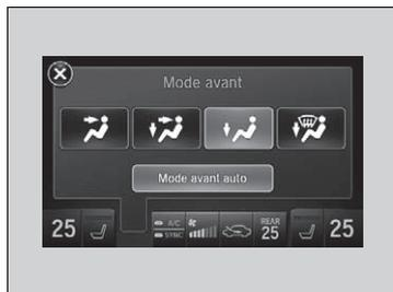
Sélectionner l'icône du mode des bouches d'air désiré, ou **Mode avant auto** : Le système sélectionne automatiquement le mode de bouche d'air le plus approprié en fonction de l'air ambiant.
