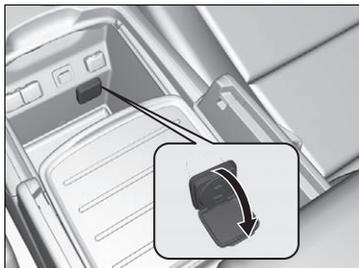
Ouvrir le couvercle pour l'utiliser. Brancher l'appareil sans l'enfoncer, le tourner de 90° vers la droite, puis le pousser complètement.
