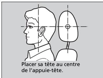
Les appuie-tête sont plus efficaces pour une protection contre le coup de fouet cervical et autres blessures infligées par une collision avec choc arrière lorsque le milieu de la tête de l'occupant est appuyé au centre de l'appuie-tête. Le haut des oreilles de l'occupant doit au niveau du centre de la hauteur de l'appuie-tête.
