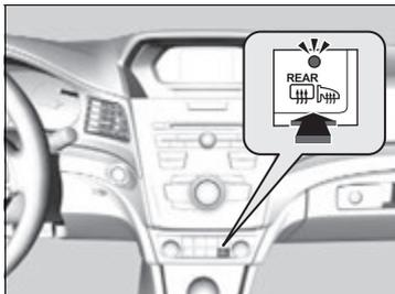
Appuyer sur le bouton du désembueur de lunette et de rétroviseurs latéraux chauffants pour désembuer la lunette et les rétroviseurs lorsque le mode d'alimentation est à MARCHE.
