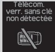
Les rappels sonores peuvent retentir à l'intérieur et/ou à l'extérieur du véhicule afin de rappeler au conducteur que la télécommande d'accès sans clé est à l'extérieur du véhicule. Si le rappel sonore continue de retentir même une fois que la télécommande est rapportée à l'intérieur du véhicule, placer la télécommande dans sa portée opérationnelle.
