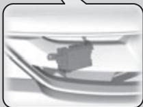
Le capteur radar se trouve dans la calandre avant.
