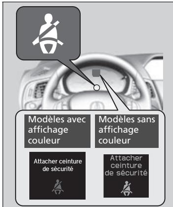
Le véhicule surveille l'utilisation des ceintures de sécurité avant. Si le mode d'alimentation passe à MARCHE avant que la ceinture de sécurité du conducteur ne soit bouclée, un signal sonore retentira et le témoin clignotera. Si le conducteur ne boucle pas sa ceinture de sécurité avant l'arrêt du signal sonore, le témoin restera allumé.
