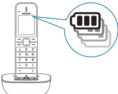
L'icône de batteries indique le niveau actuel de charge des batteries.
