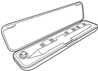
**Important :** pour préserver la sensibilité de votre outil de saisie, ne le rangez pas sur un support où il reposera sur sa pointe ou sa gomme. Un rangement inapproprié peut endommager le(s) capteur(s) de pression de la pointe du stylet.
