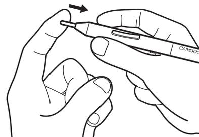
2. Introduisez l'extrémité de la nouvelle pointe dans le fourreau du stylet. Poussez fermement la pointe jusqu'à ce qu'elle se bloque.
