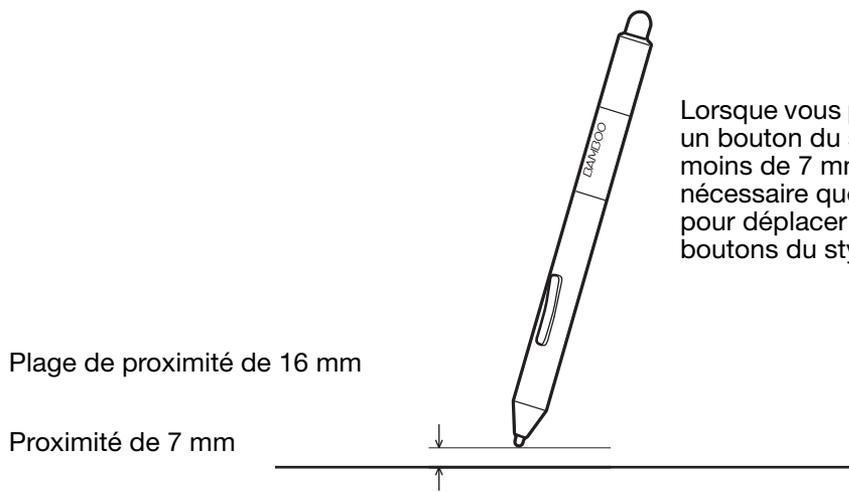
Lorsque vous positionnez le curseur de l'écran et utilisez un bouton du stylet, la pointe de stylet doit être située à moins de 7 mm de la surface de la tablette. Il n'est pas nécessaire que la pointe soit en contact avec la tablette pour déplacer le curseur à l'écran ou utiliser l'un des boutons du stylet.
