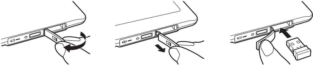
Pour retirer le récepteur de la tablette, ouvrez le compartiment. Faites partiellement glisser l'entretoise à l'extérieur de la tablette. Retirez le récepteur de l'entretoise. Remettez en place l'entretoise en la faisant glisser, puis fermez le couvercle du compartiment de stockage.
